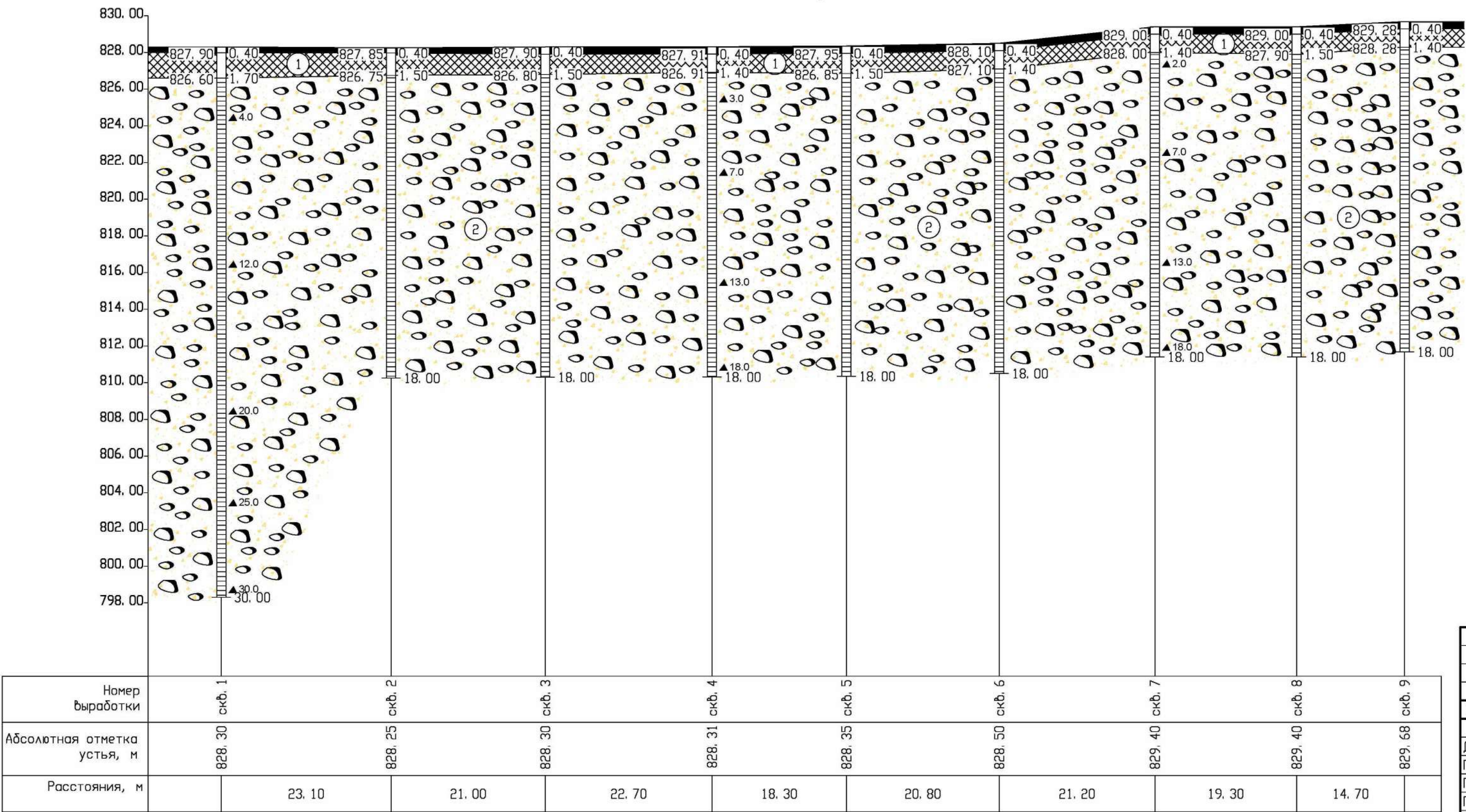
Инженерно-геологический разрез по линии I - I Масштаб: гориз. 1:500 вертик 1:200
