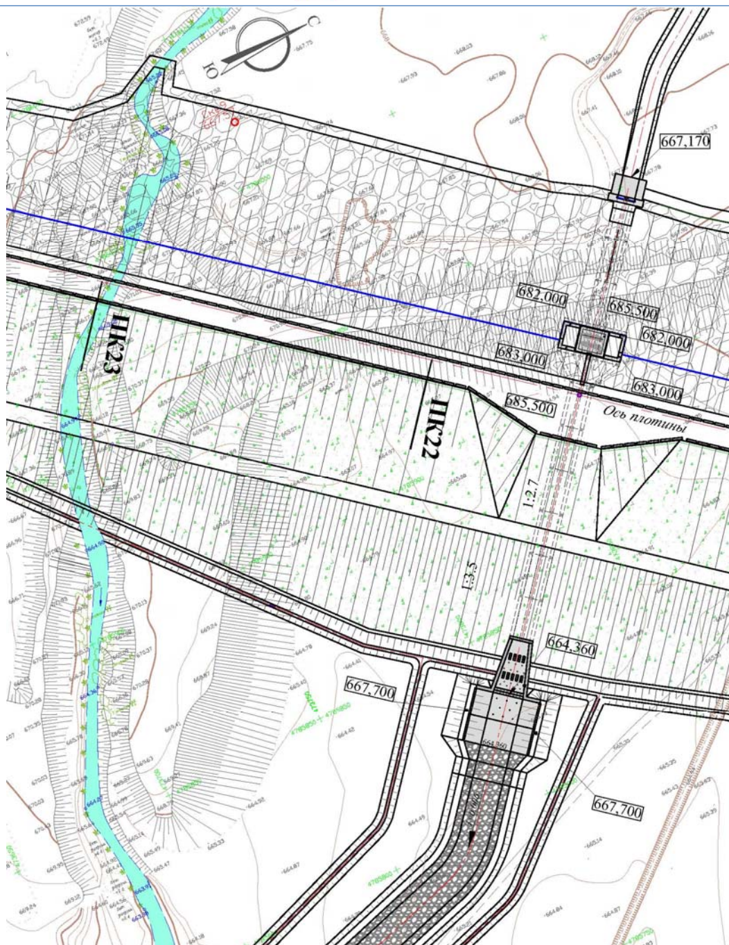
Рис.6.4.1. План эксплуатационного водовыпуска с шахтным водосбором
