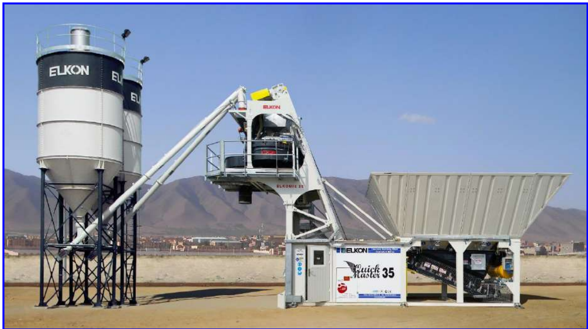
Фото-1. Общий вид установки по производству бетона
