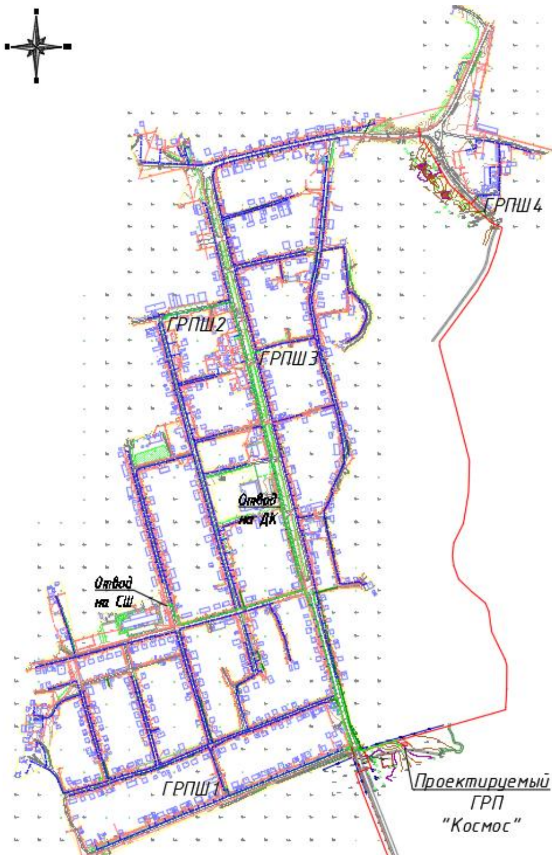
Рисунок 1.2 Схема расположения газопровода и ГРПШ внутри поселка
