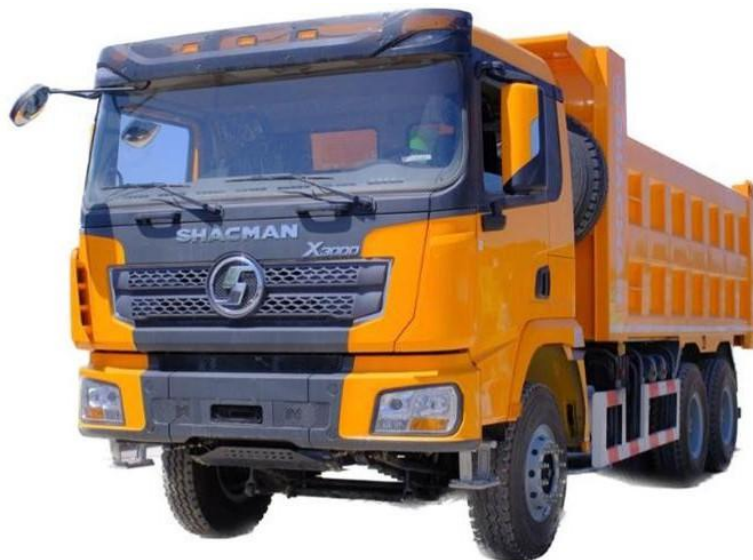
Рисунок 4— Самосвал SHACMAN X3000 грузоподъемностью 25 т Специальная техника и оборудование:
