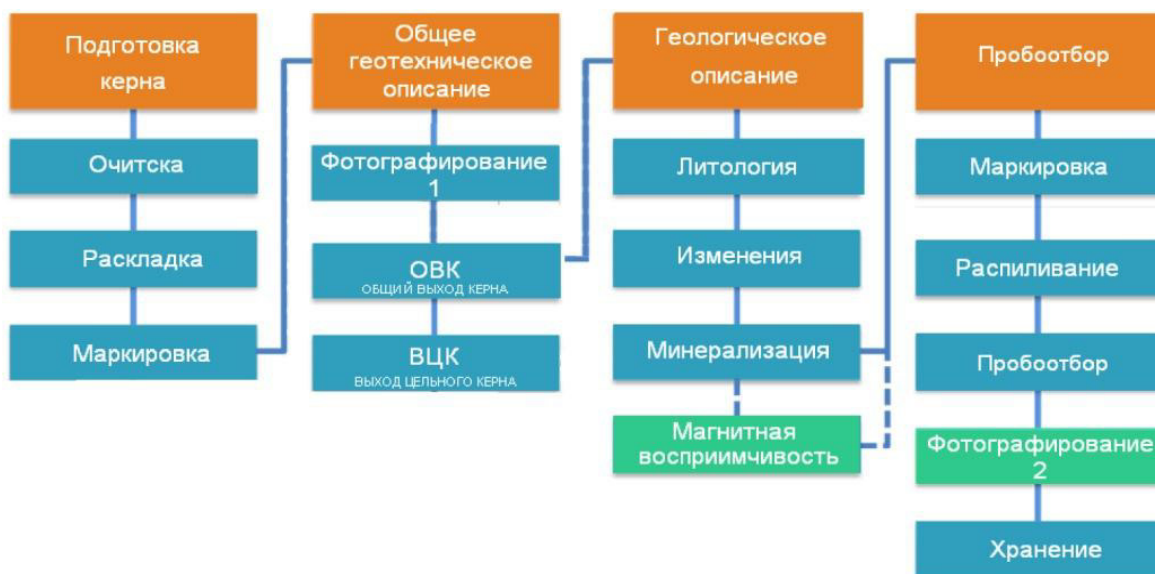
Рис. 4 Технологическая схема документации и обработки керна
