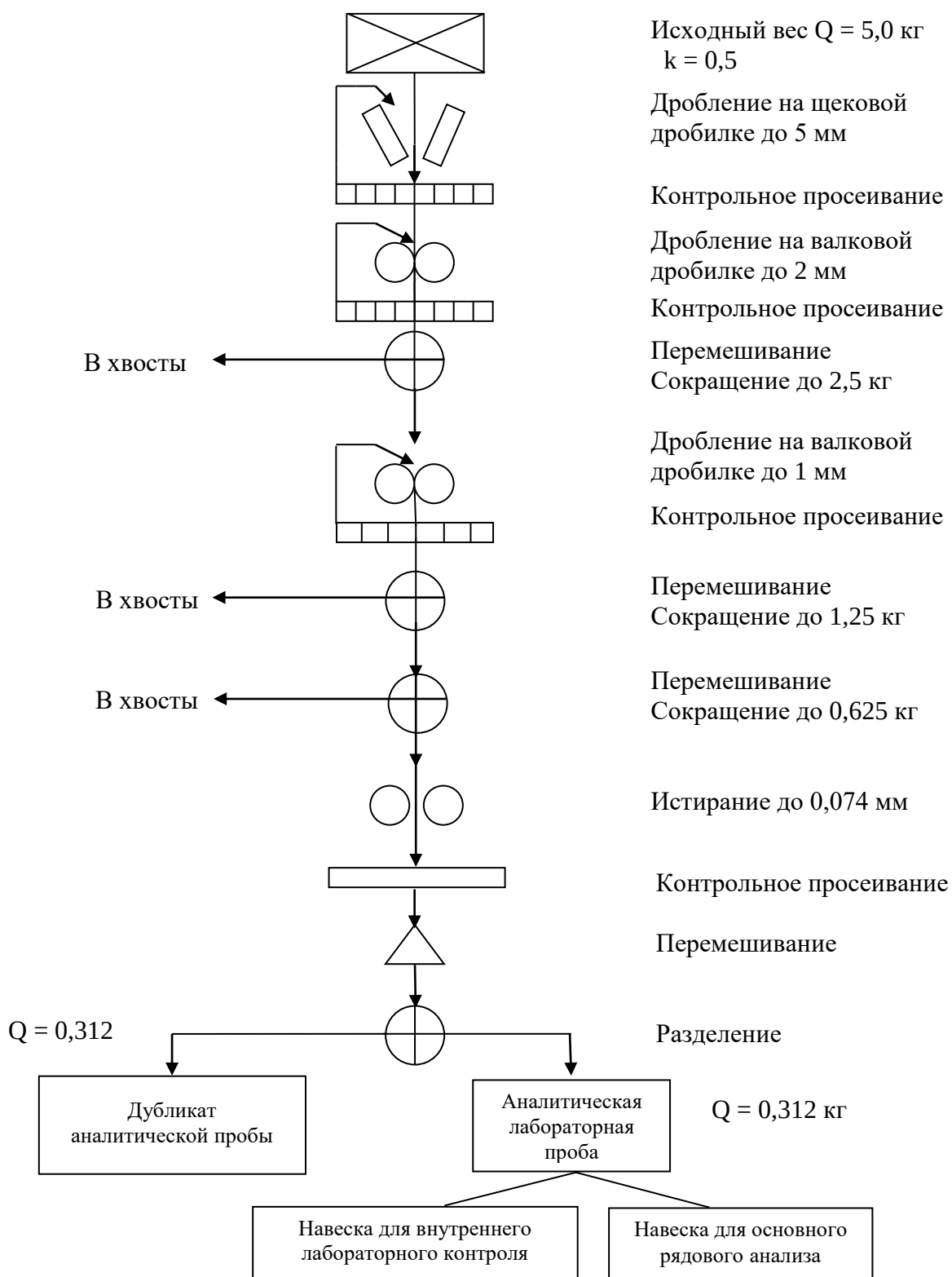
Рис. 4.3 Схема обработки керновых проб
