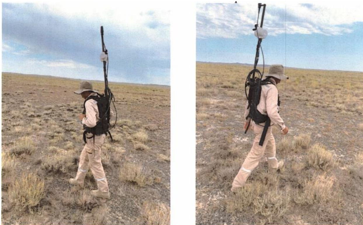
Рис. 4.2. Магниторазведочные работы с использованием магнитометра
