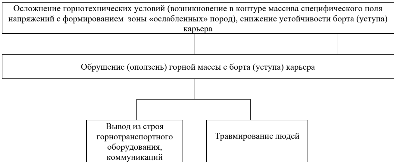
Рисунок 8.1 - Блок-схема вероятного сценария аварии при обрушении (оползней) горной массы с борта (уступа) карьера
