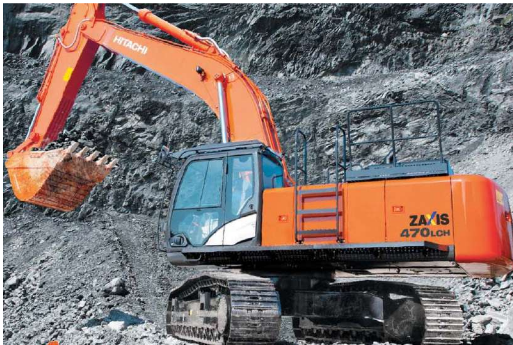
Рисунок 5.8 Гидравлический экскаватор Hitachi 470-5G с ковшом 2,1 м 3
