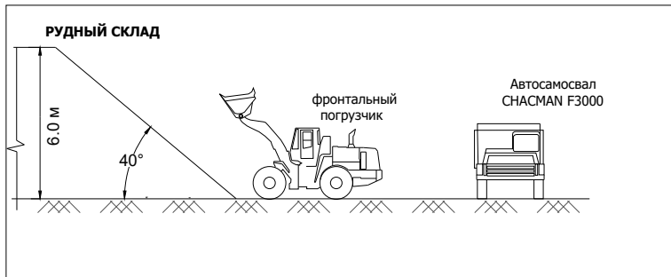
Схема погрузки руды фронтальным погрузчиком в автосамосвал
