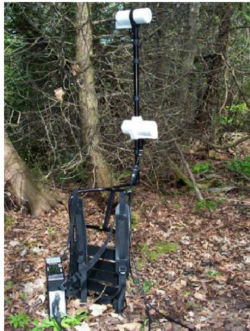
Рис. 5.11.1 Магнитометр GSM-19 в рабочем положении
