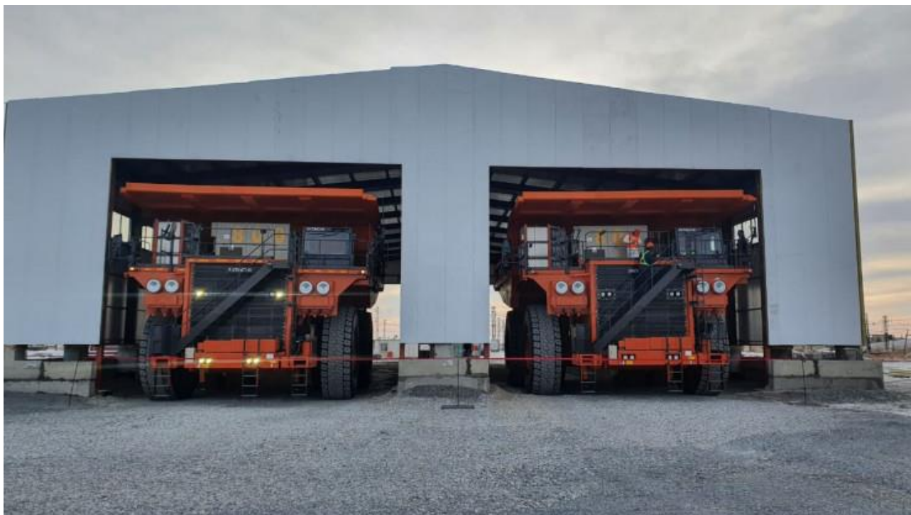
Рисунок 1.3.1 – Самосвалы 220-тонные Hitachi
