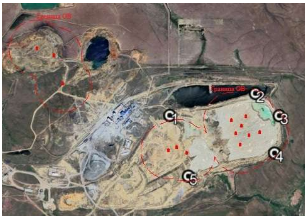
Рисунок 3.2. Граница области химического воздействия на атмосферный воздух при проведении работ по рекультивации временного хвостохранилища НОФ
