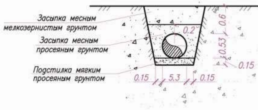
Рис. 3.2.1 – Прокладка газопровода на скальных участках
