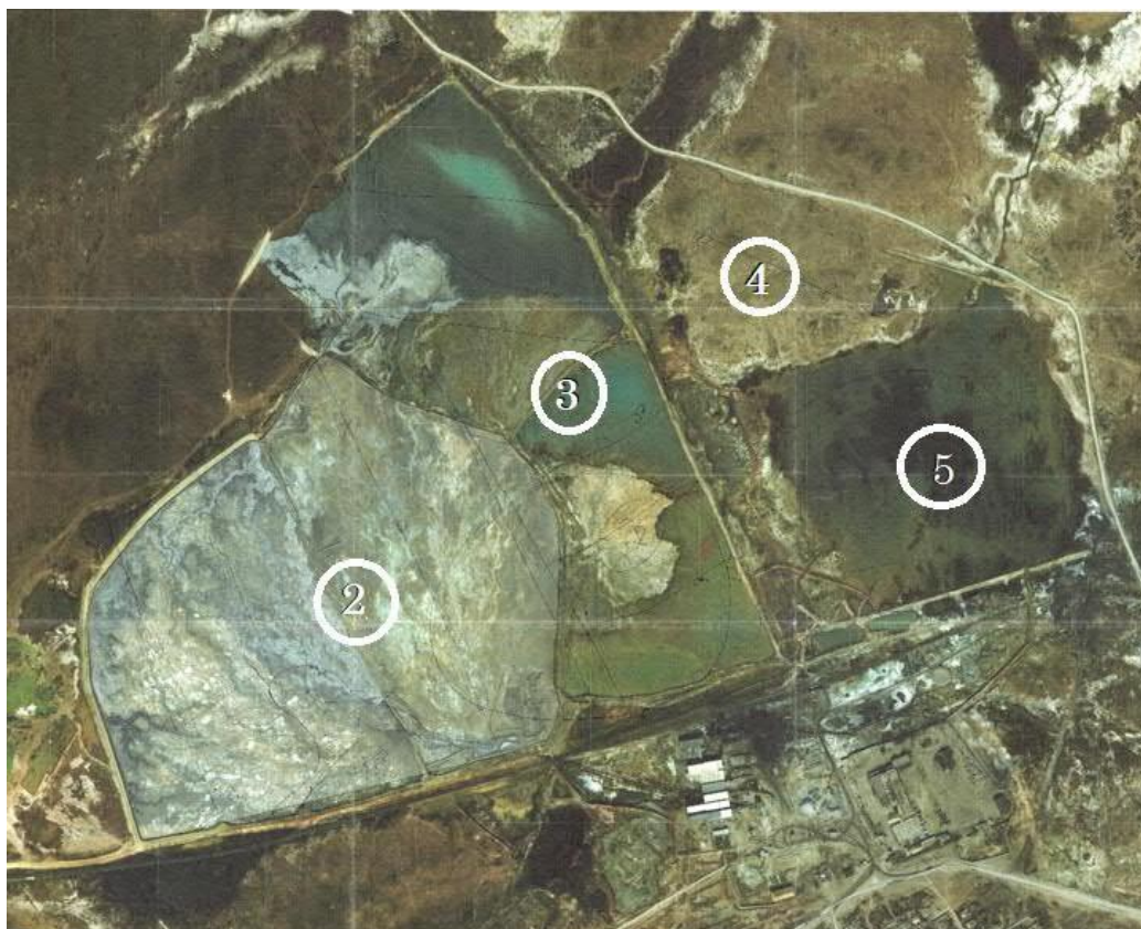
Рис.1.1 - Космоснимок Хвостохранилища № 2 Майкаинской обогатительной фабрики - Секции № 2, 3, 4, 5 (пиритохранилище)
