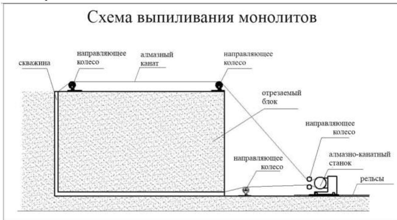
Рис. 4.1. Схема выпиливания монолитов
