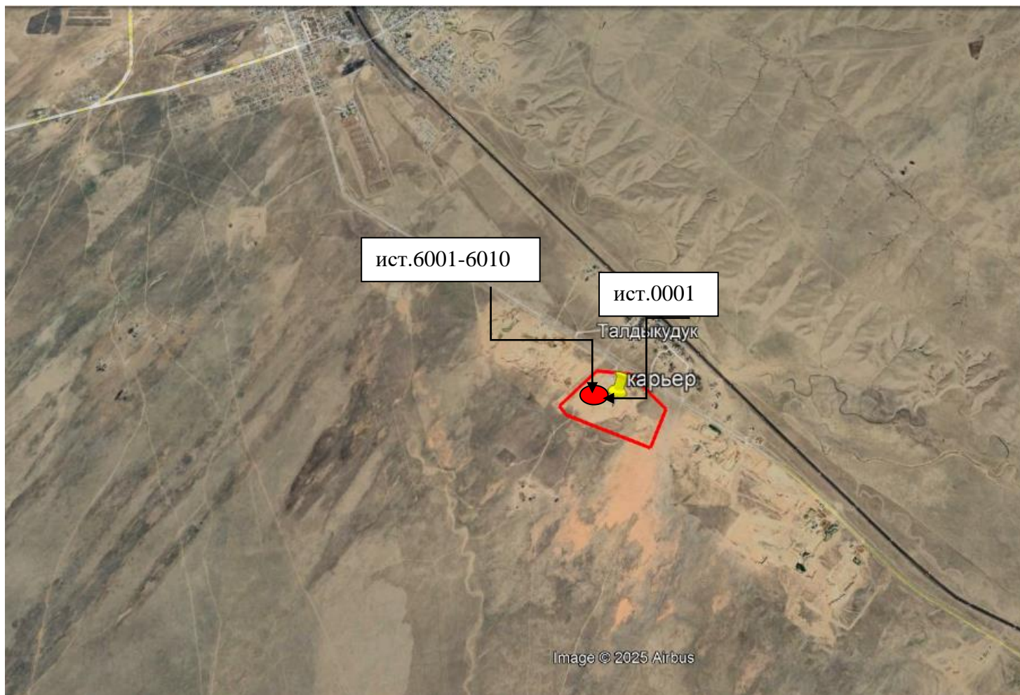
Рис.2. Карта-схема объекта с нанесенными на нее источниками выбросов загрязняющих веществ в атмосферу
