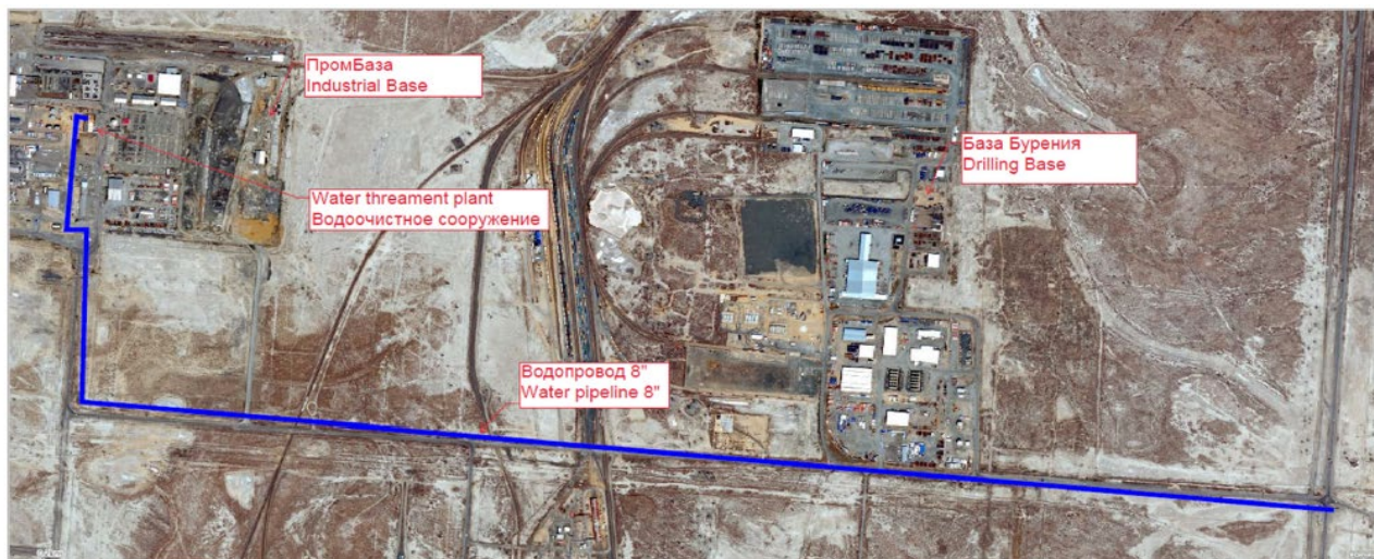
Рисунок 1.8.1. Схема трассы существующего трубопровода, подлежащего замене
