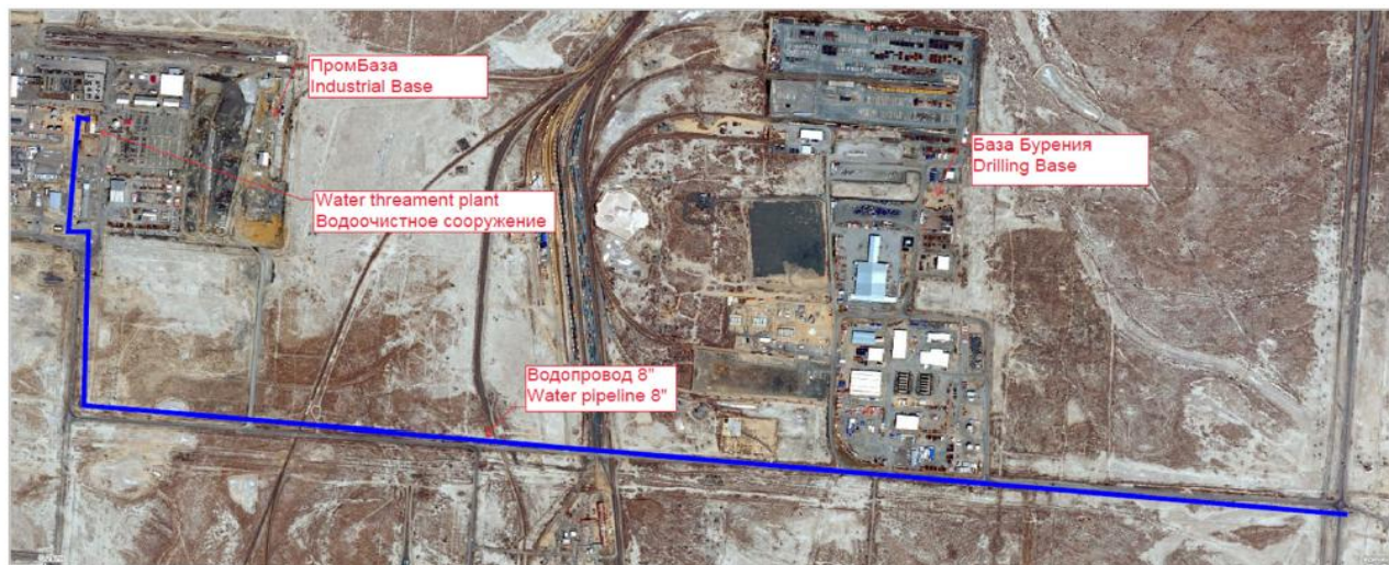
Рисунок 1.7.1. Схема трассы существующего трубопровода, подлежащего замене
