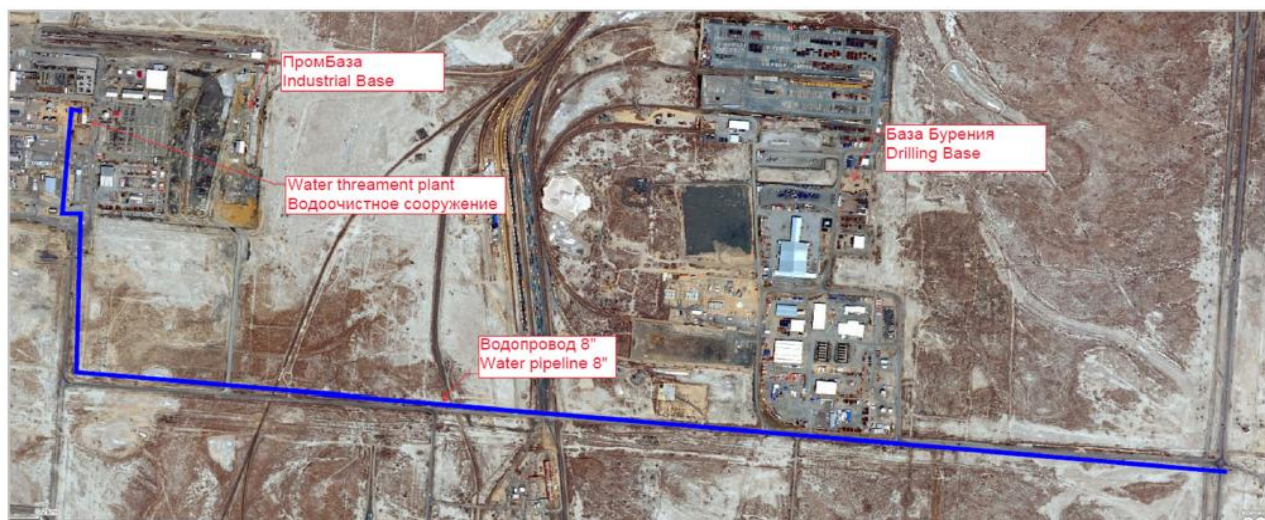
Сурет 1.7.1. Ауыстыруға жататын қолданыстағы құбыржолдың трасса сызбасы
