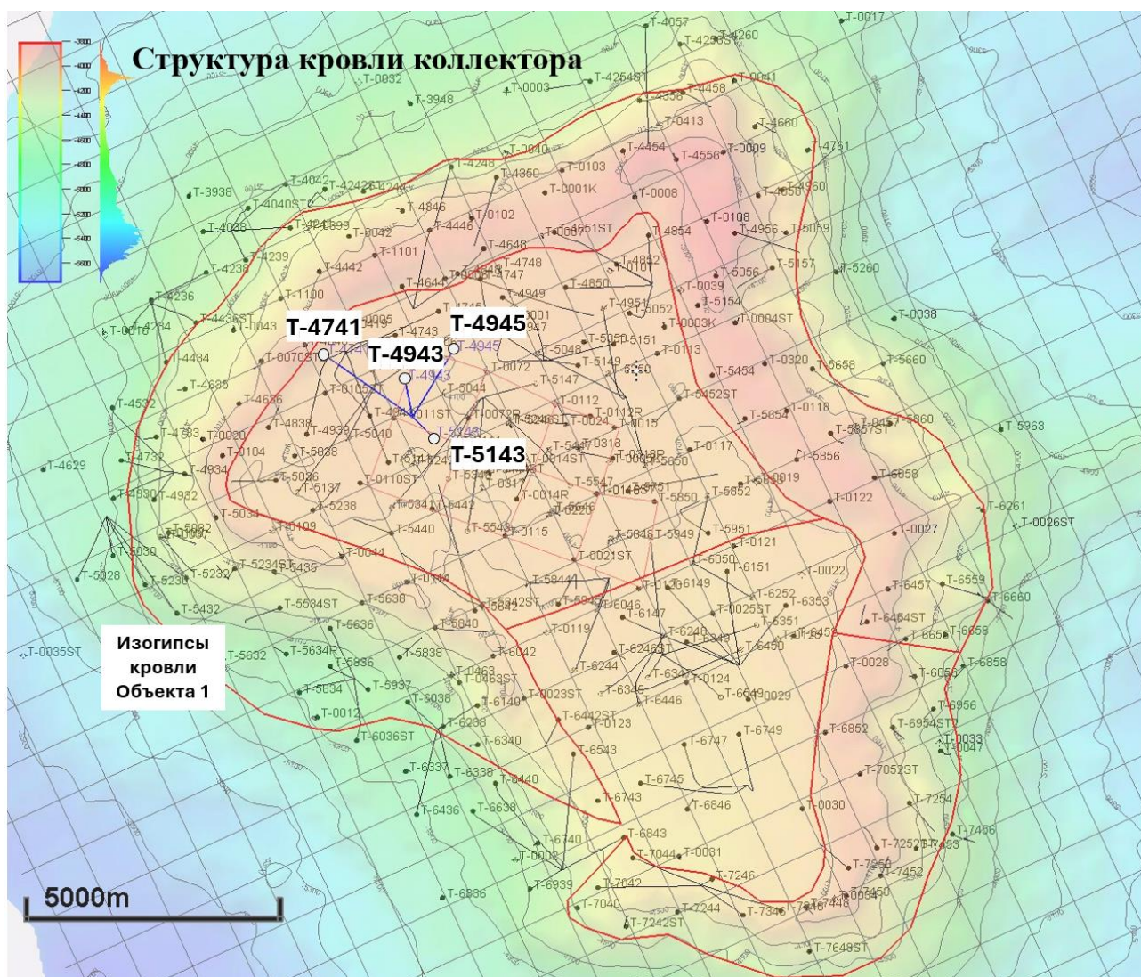
Рисунок 1.3. Структура кровли коллектора
