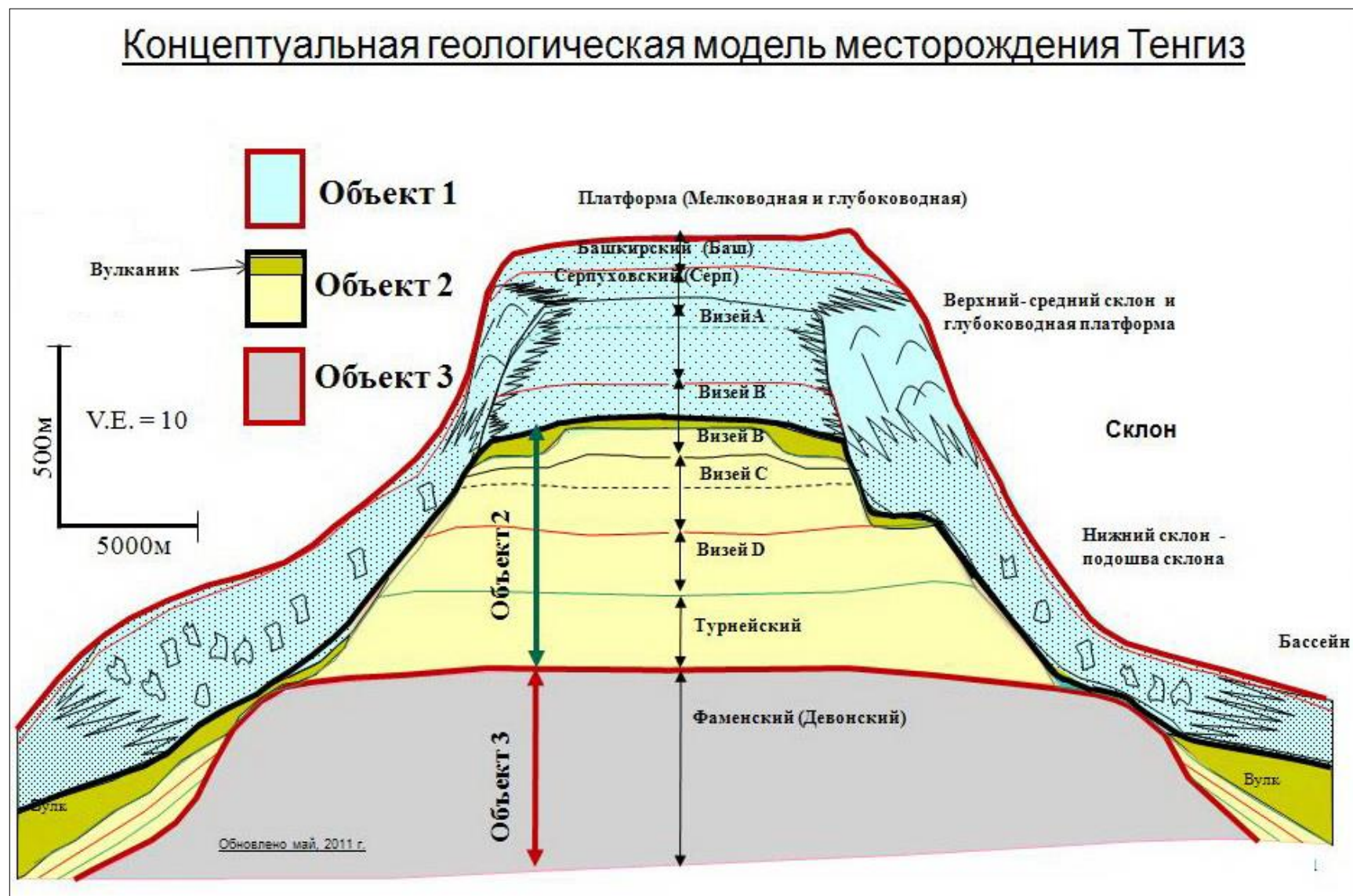
Рисунок 1.2: Геологическая модель Тенгизской карбонатной платформы
