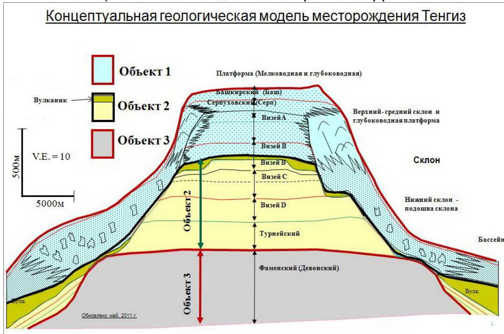
Рисунок 1.2. Геологическая модель Тенгизской карбонатной платформы
