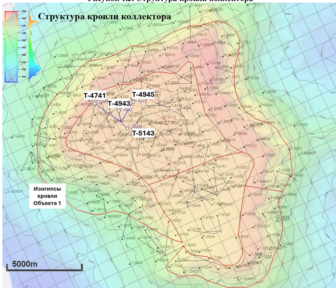
Рисунок 1.3. Структура кровли коллектора
