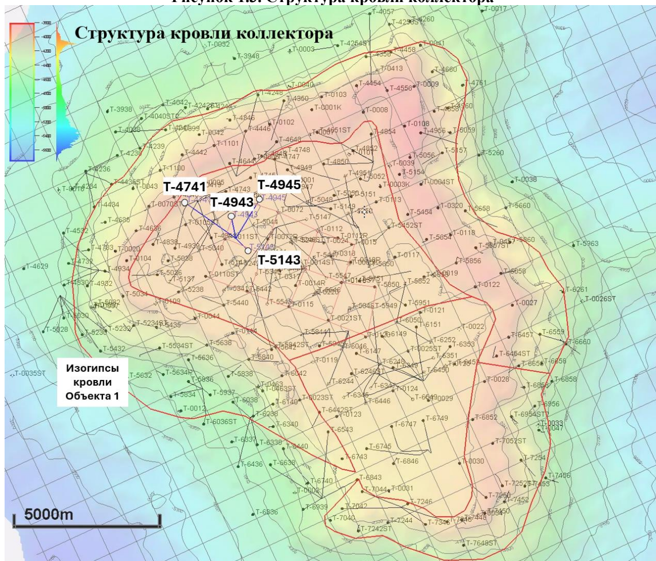
Рисунок 1.3. Структура кровли коллектора
