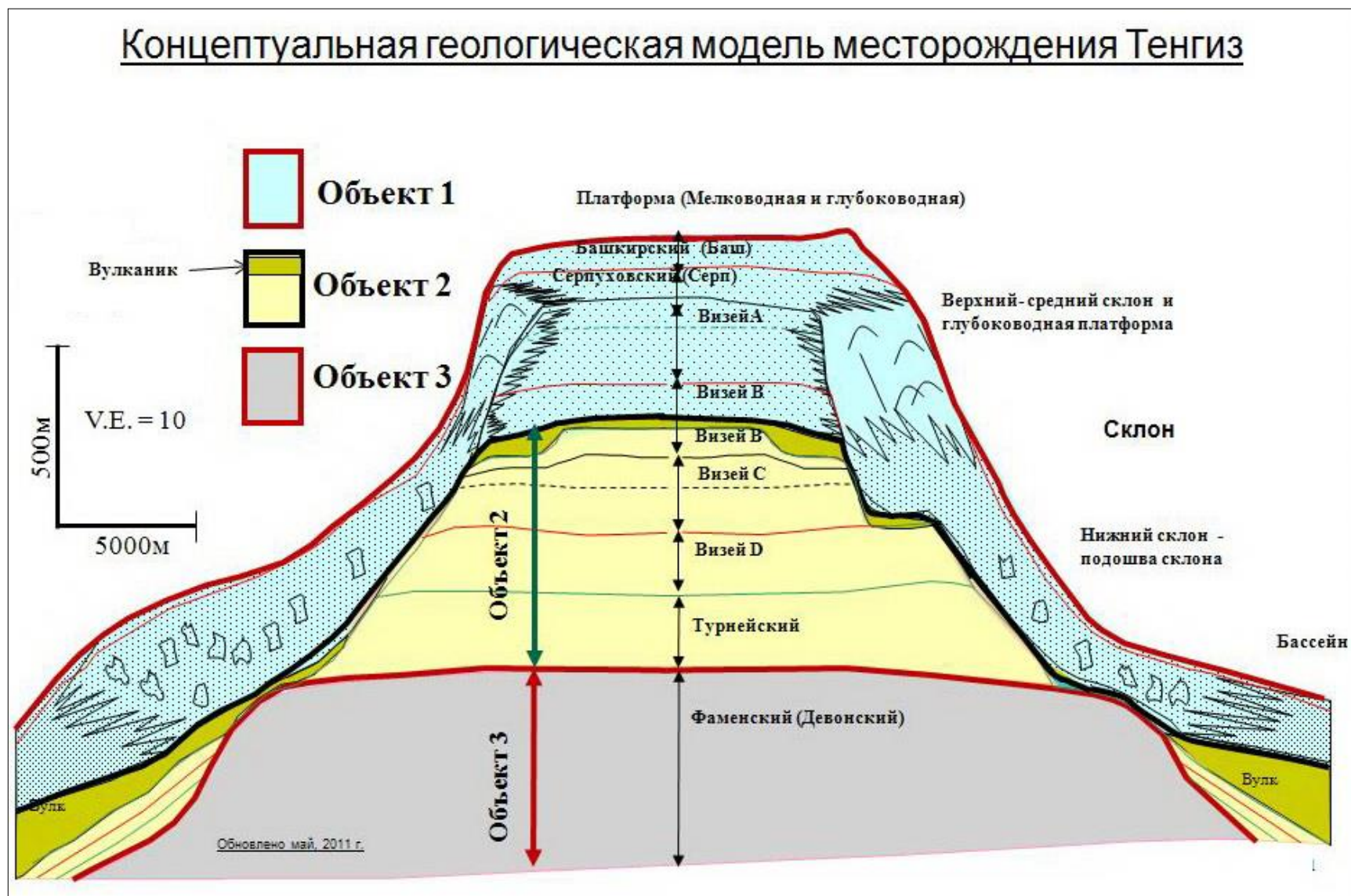
Рисунок 1.2: Геологическая модель Тенгизской карбонатной платформы
