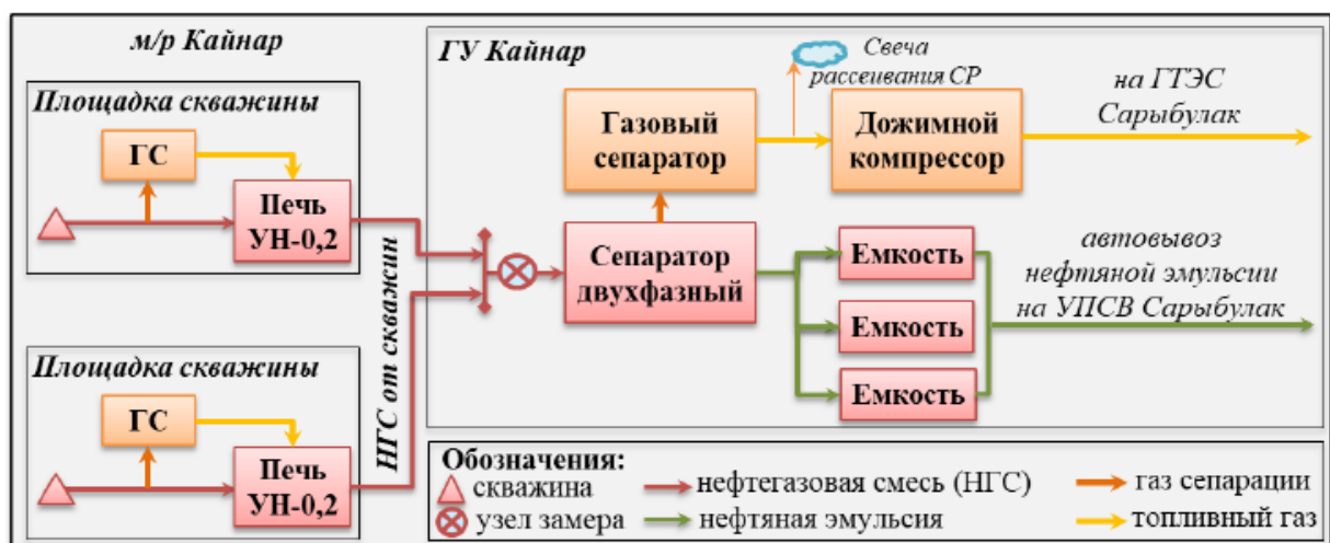
Рисунок 3.2 – Принципиальная блок-схема системы сбора и транспортировки добываемой продукции месторождения Кайнар
