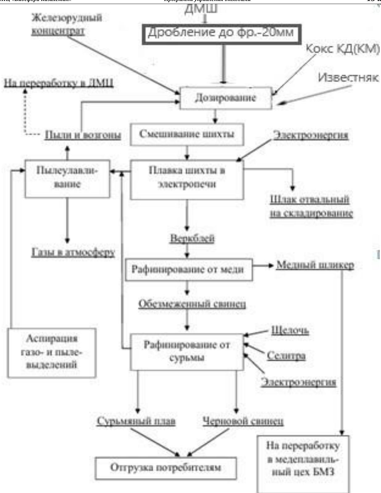
Рисунок 2 — Принципиальная технологическая схема переработки драгметалльного шлака.
