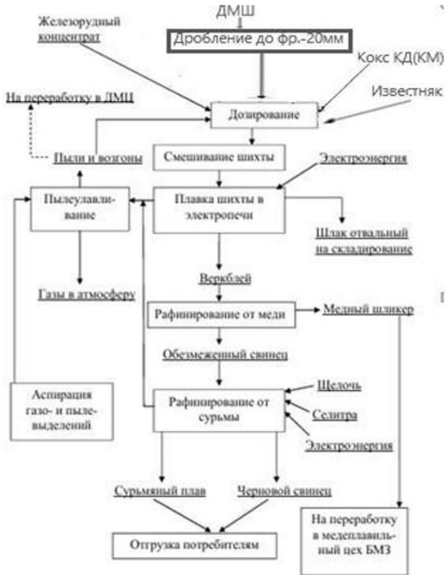
Рисунок 2 — Принципиальная технологическая схема переработки драгметалльного шлака
