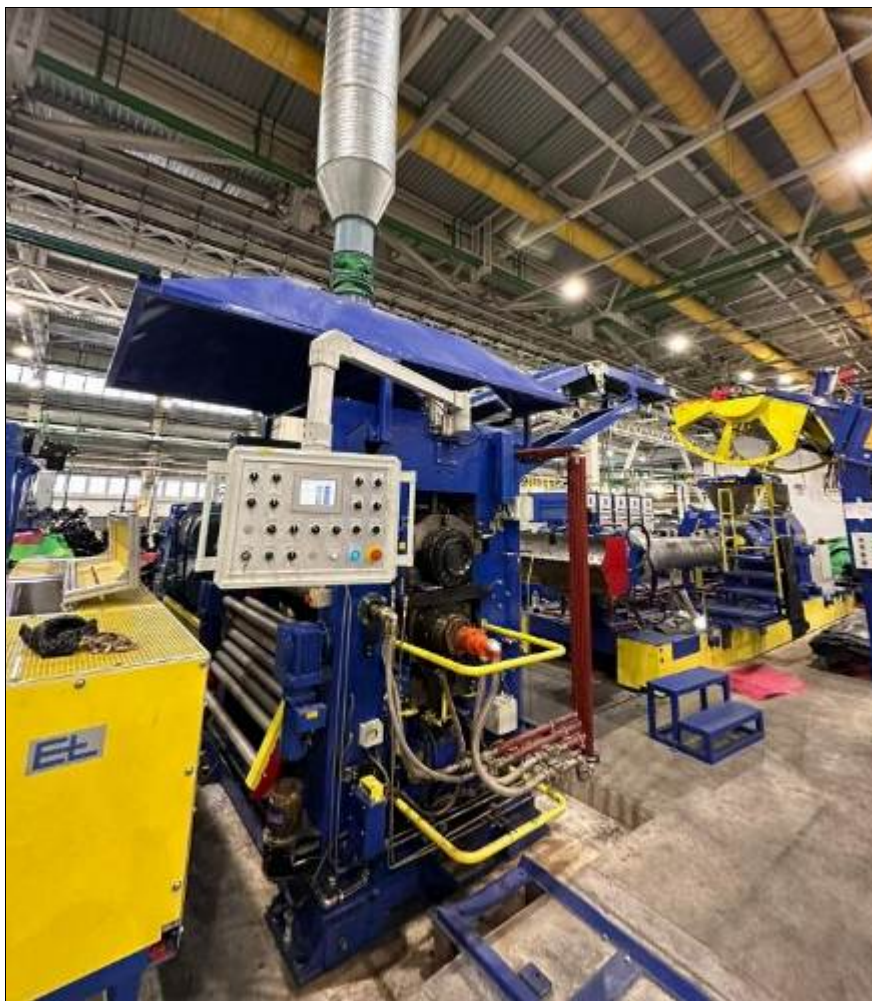
Рисунок 3.32 – Экструзионная линия по выпуску герметизирующего слоя
