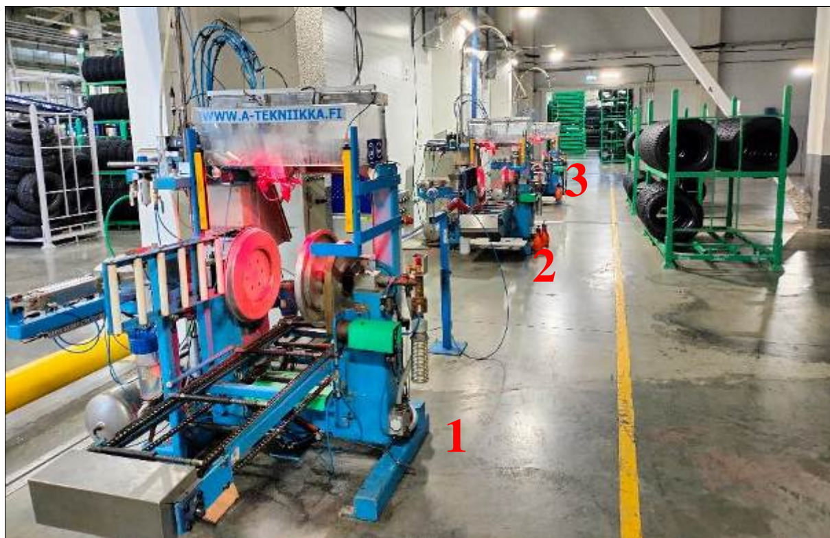
Рисунок 3.26 – Станки для шипования резины
