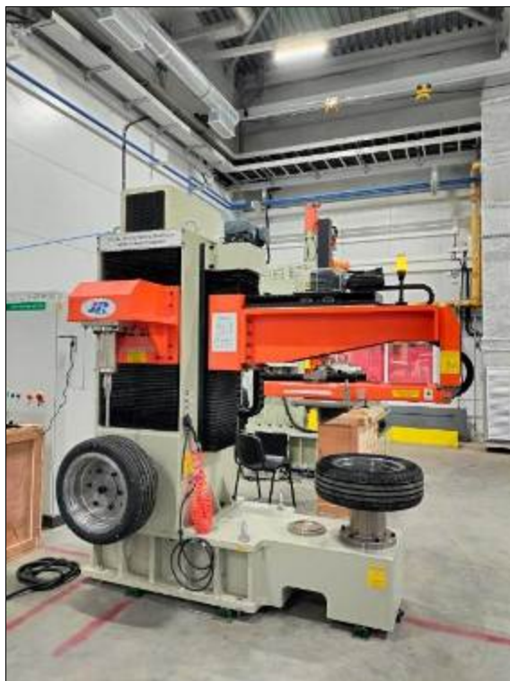
Рисунок 3.58 – Испытательные стенды для шин на смещение бортов, определение энергии разрыва и снятие отпечатка
