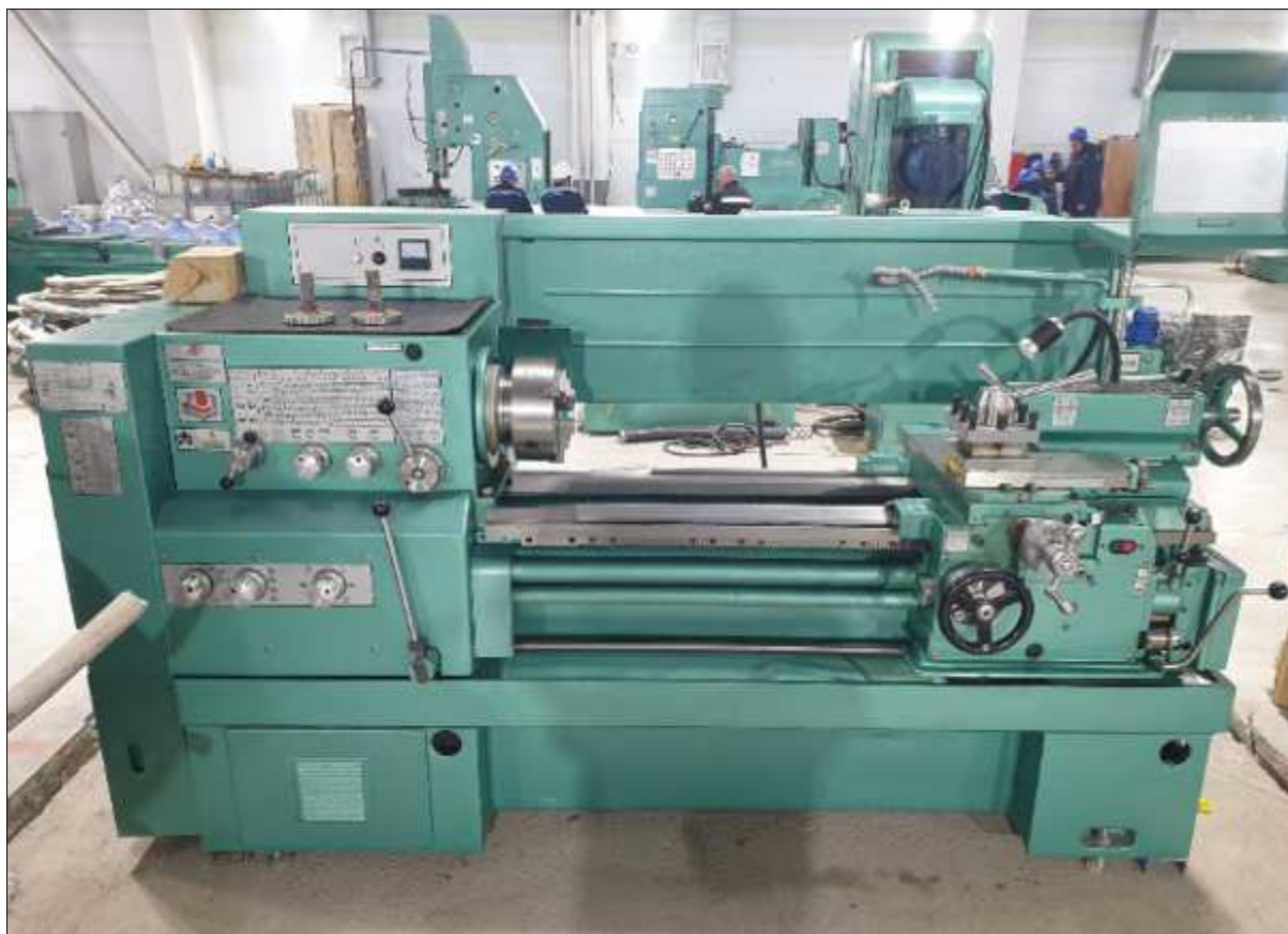
Рисунок 3.45 – Станок токарно-винторезный Модель 16K20
