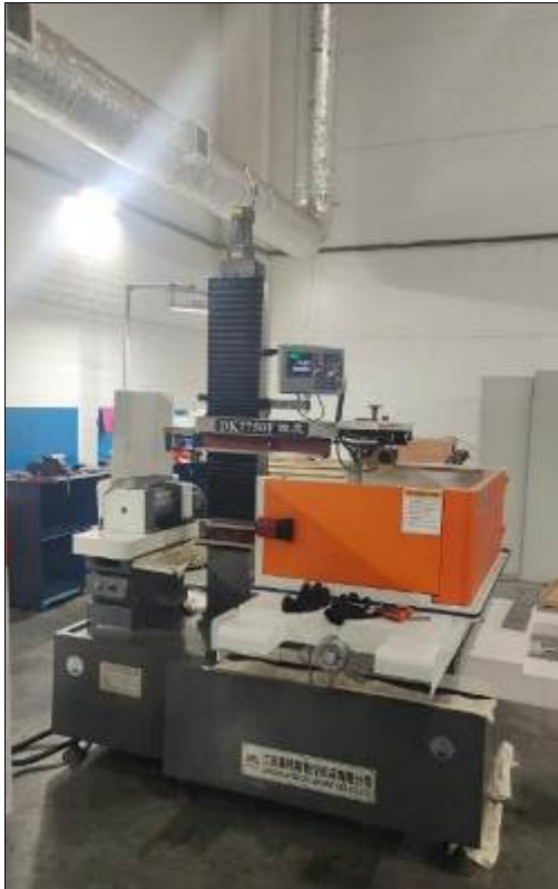
Рисунок 3.49 – Электроэрозионный проволочно-вырезной станок с ЧПУ струйного типа серии METAL MASTER DK 7750F DRO
