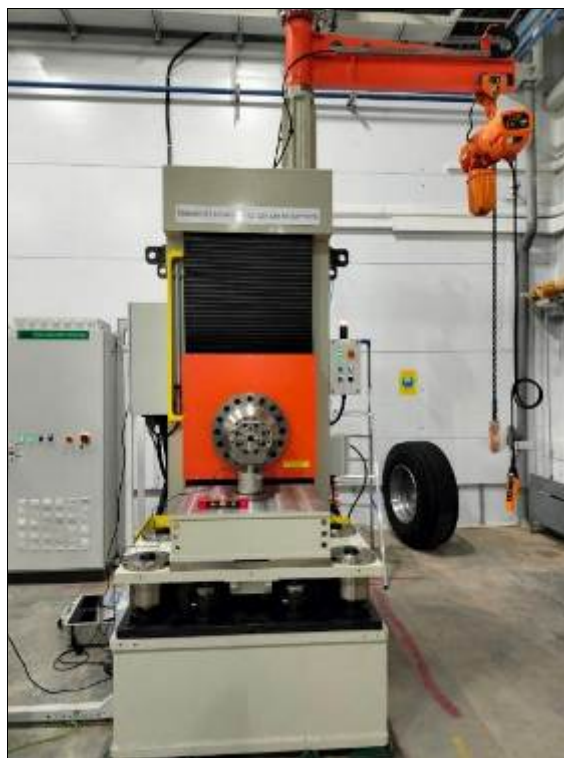
Рисунок 3.58 – Испытательные стенды для шин на смещение бортов, определение энергии разрыва и снятие отпечатка
