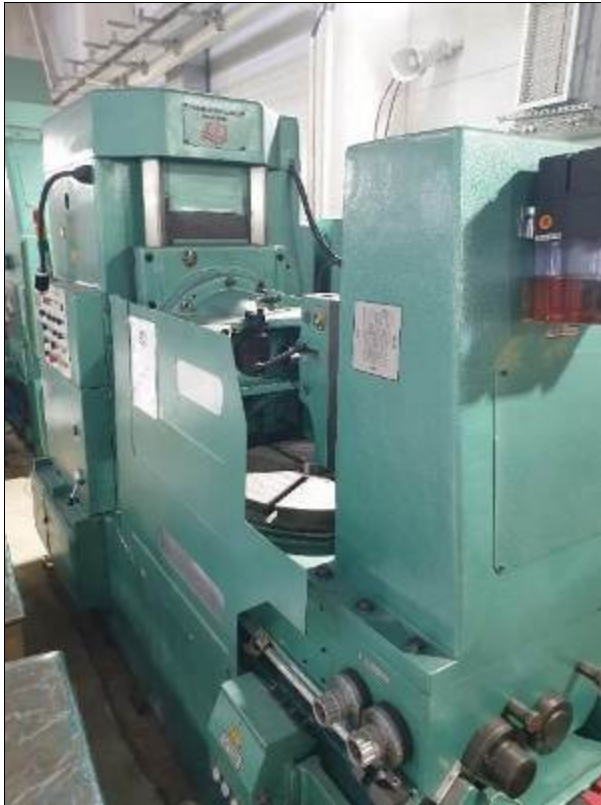
Рисунок 3.36 – Зубофрезерный станок Мо- дель 53A80
