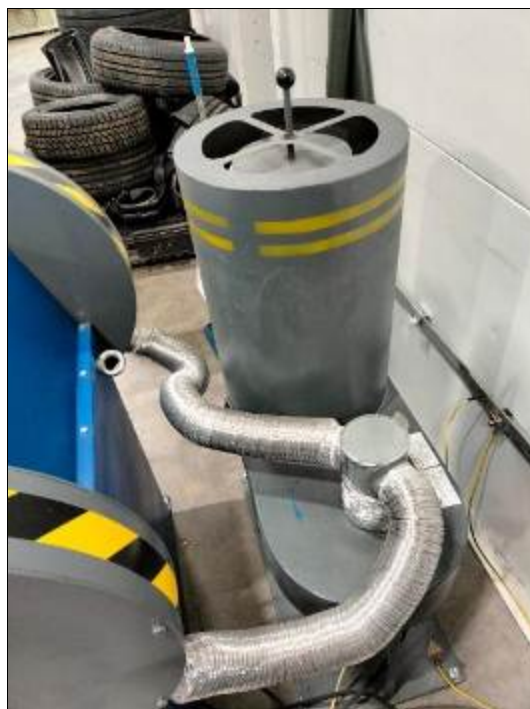
Рисунок 3.59 – Точноно-шлифовальный станок с системой местного отсоса
