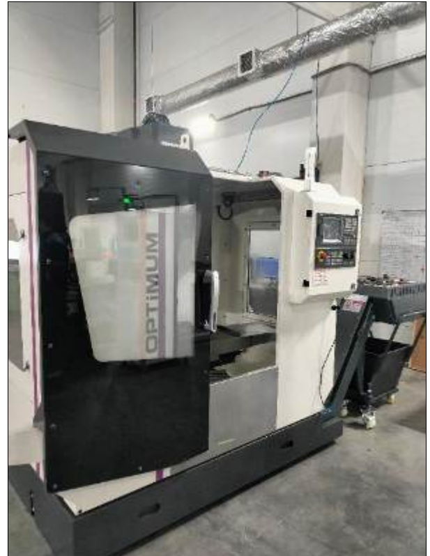
Рисунок 3.50 – Фрезерный станок OPTLimill F 80 3-осевой
