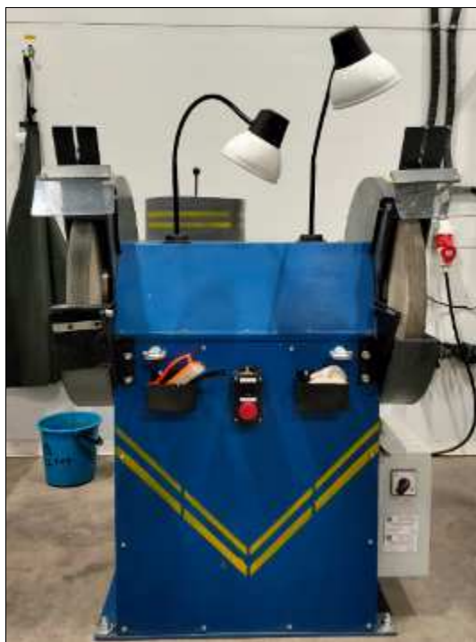
Рисунок 3.59 – Точноно-шлифовальный станок с системой местного отсоса
