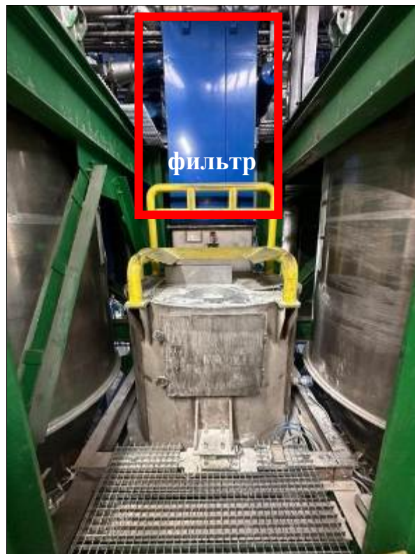
Рисунок 3.16 – Бункер с цинковыми белилами / окисью цинка (3 этаж)
