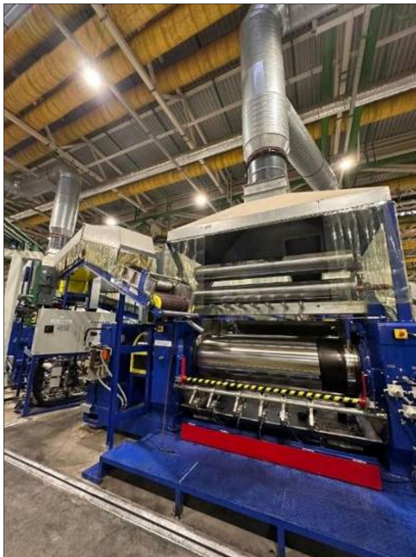
Рисунок 3.30 – Вальцы экструзионной линии изготовления протекторов
