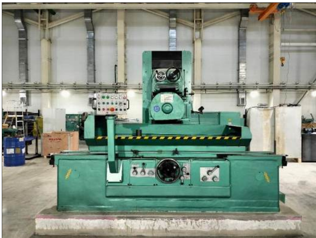
Рисунок 3.42 – Станок плоскошлифовальный с горизонтальным шпинделем Модель 3Л722В
