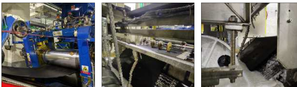
Рисунок 3.18 – Выход резиновой смеси из экструдера через валки на ванну с антиадгезивом
