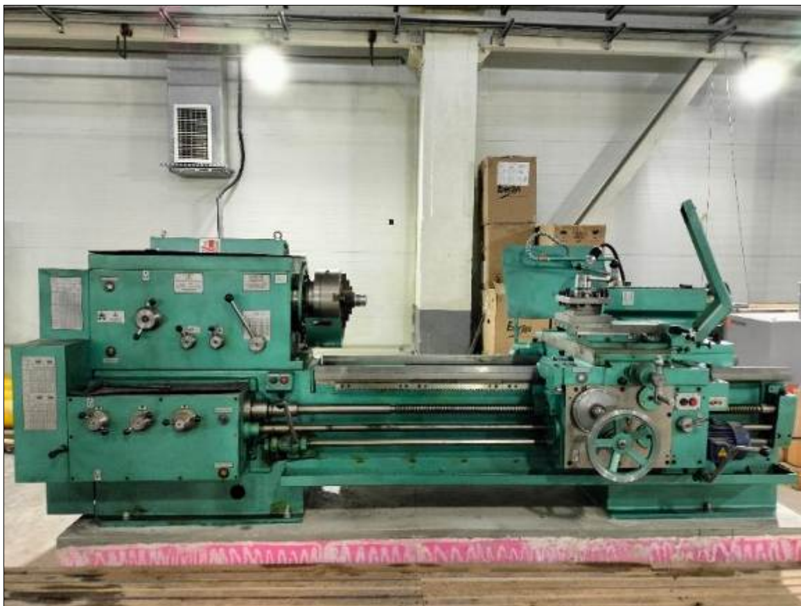
Рисунок 3.43 – Станок токарно–винторезный Модель 1М63
