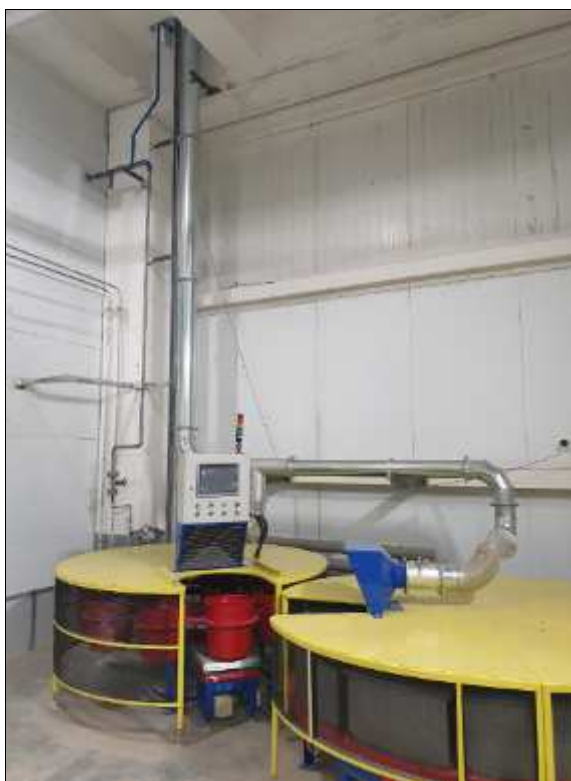
Рисунок 3.10 – Весы технические (карусель) для финальных резиновых смесей (2 этаж)
