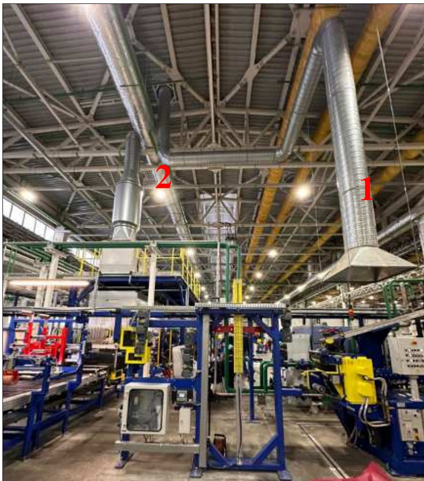
Рисунок 3.28 – Экструзионные линии выпуска мелких компонентов
