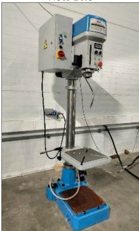
Рисунок 3.51 – Вертикально-сверлильный станок Stalex SHD-32 PF
