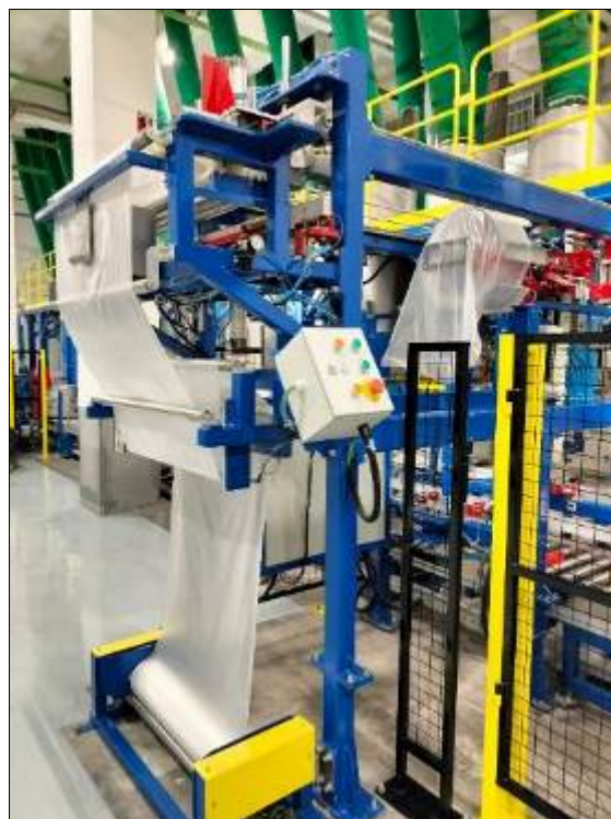
Рисунок 3.9 – Аппарат для пайки полиэтиленовых пакетов 2 этаж
