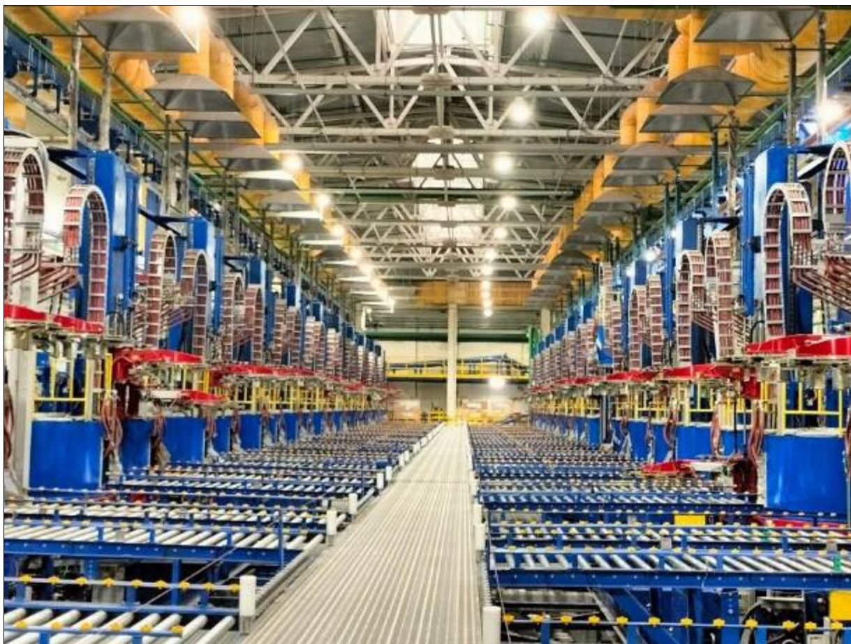
Рисунок 3.24 – Общий вид помещения гидравлических форматоров–вулканизаторов (прессов) грузовых и легковых шин
