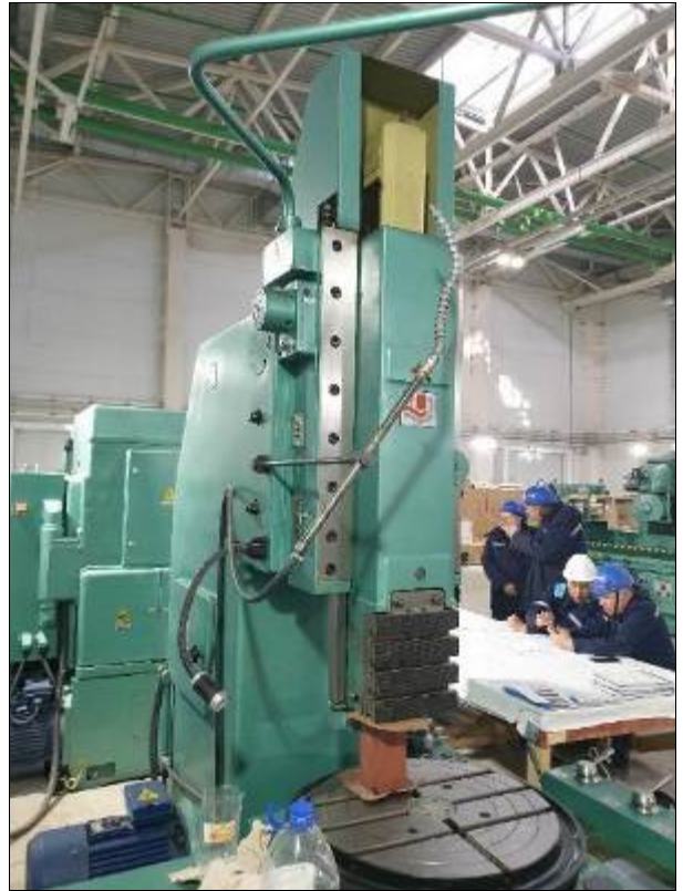
Рисунок 3.37 – Станок долбежный Модель ГД320
