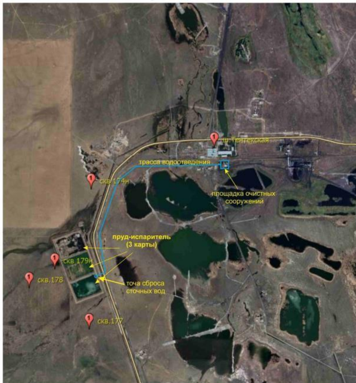
Рис 1.1 - Ситуационная карта-схема района расположения шахты «Тентекская» с указанием очистных сооружений, места выпуска и водоприемника сточных вод
