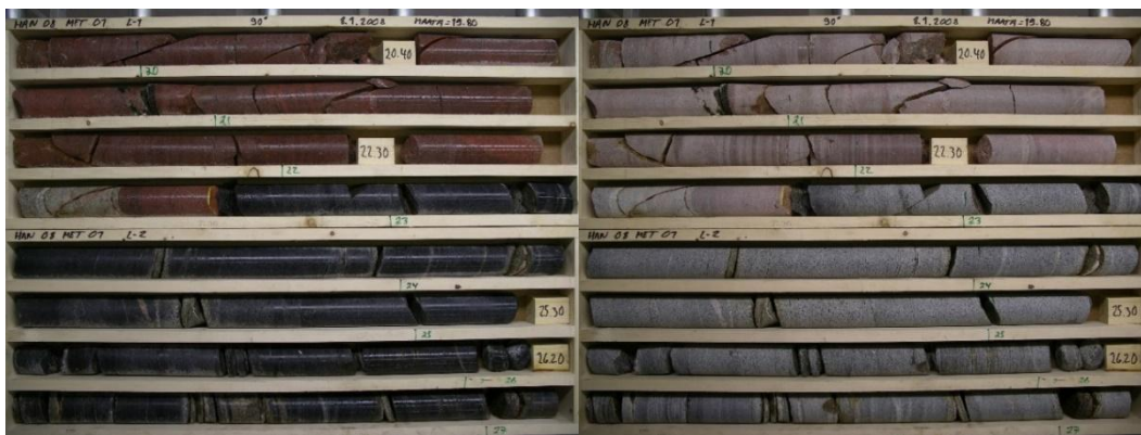
Рис. 3.4.2.1 Фотографии керновых ящиков с мокрым и сухим керном
