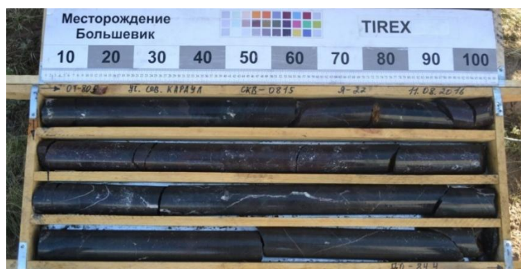
Рис. 3.4.2.2 Пример линейки и цветной/черно-белой контрольной полосы, для корректировки цветового баланса при фотографировании керна
