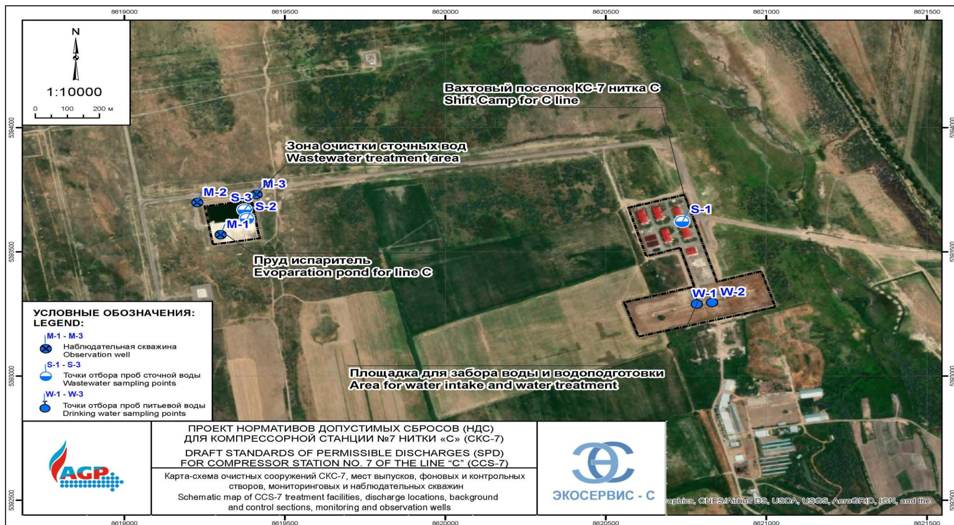
Рисунок 5.2.2.1 Схема планируемых мест расположения наблюдательных скважин на СКС-7.
