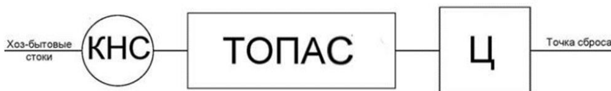
Рис.2 Технологическая схема очистки бытовых сточных вод
