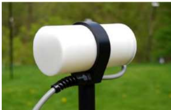
Рисунок 2 – Сенсор GSM-19 с обогащёнными свободными радикалами и приемник-регистратор GSM-19
