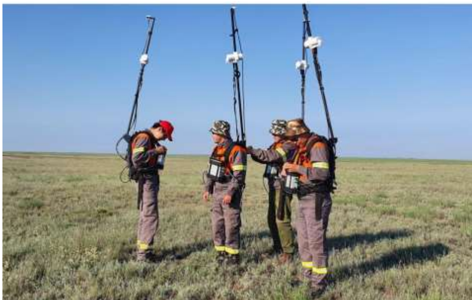
Рисунок 4 – Выполнение наземной магниторазведки с помощью модульного магнитометра GSM-19W (Канада)
