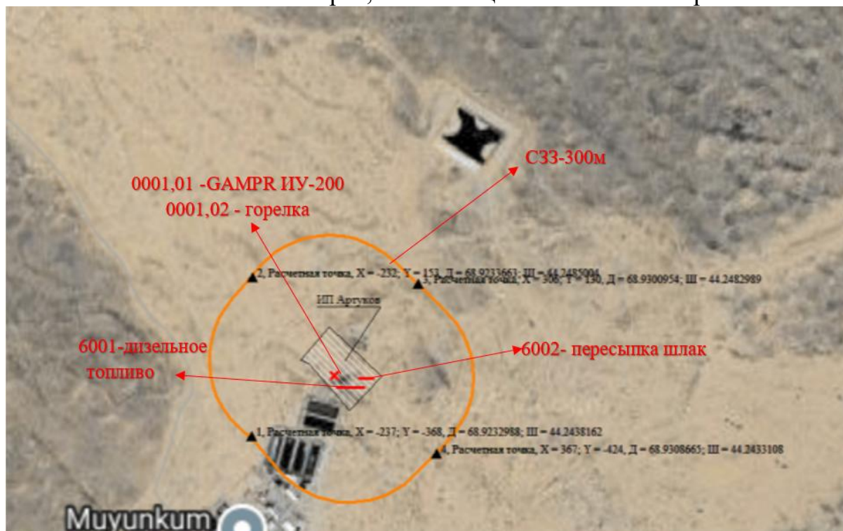
Рис 2. Схематическая карта, поясняющая источники выбросов
