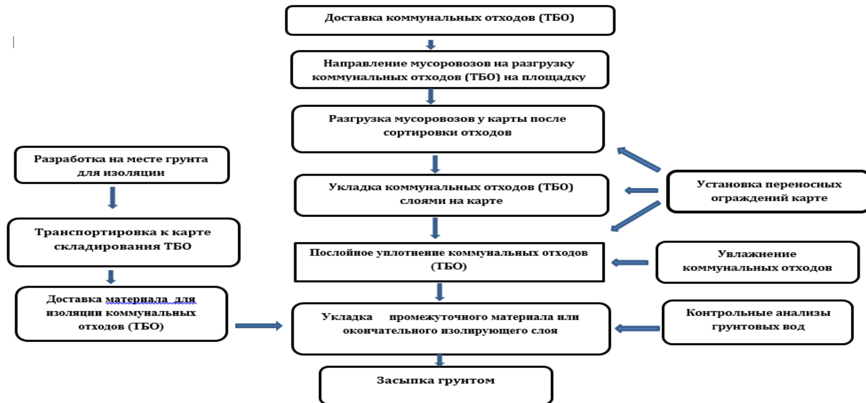
Рис. 1. Основные технологические операции при эксплуатации полигонов
