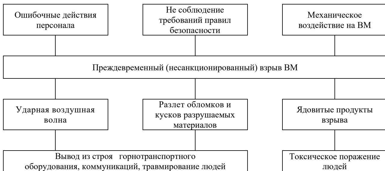
Рис.11.2 - Блок-схема вероятного сценария аварии при преждевременном (несанкционированном) взрыве ВВ при проведении взрыва в блоке с механизированным заряданием скважин
