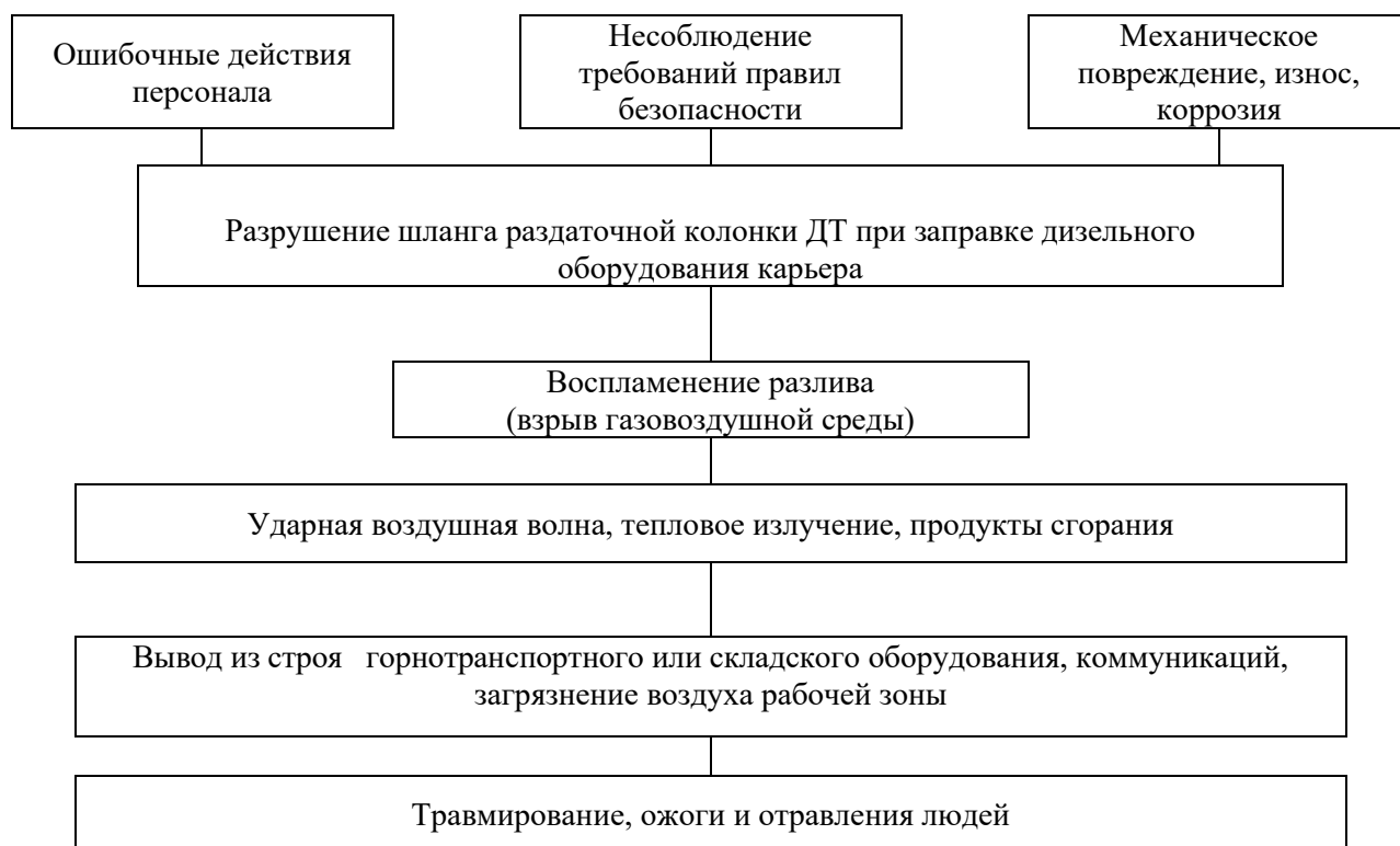
Рис.11.3 - Блок-схема вероятного сценария возникновения и развития аварии при заправке дизельного технологического оборудования карьера из топливозаправщика
