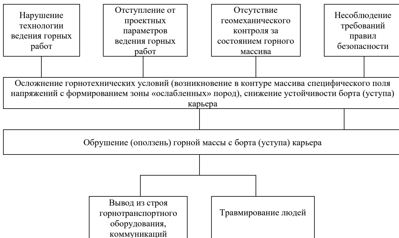
Рис.11.1 - Блок-схема вероятного сценария аварии при обрушении (оползней) горной массы с борта (уступа) карьера
