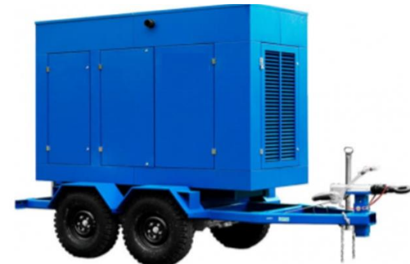
ДЭС 250 – подвижная энергетическая установка
