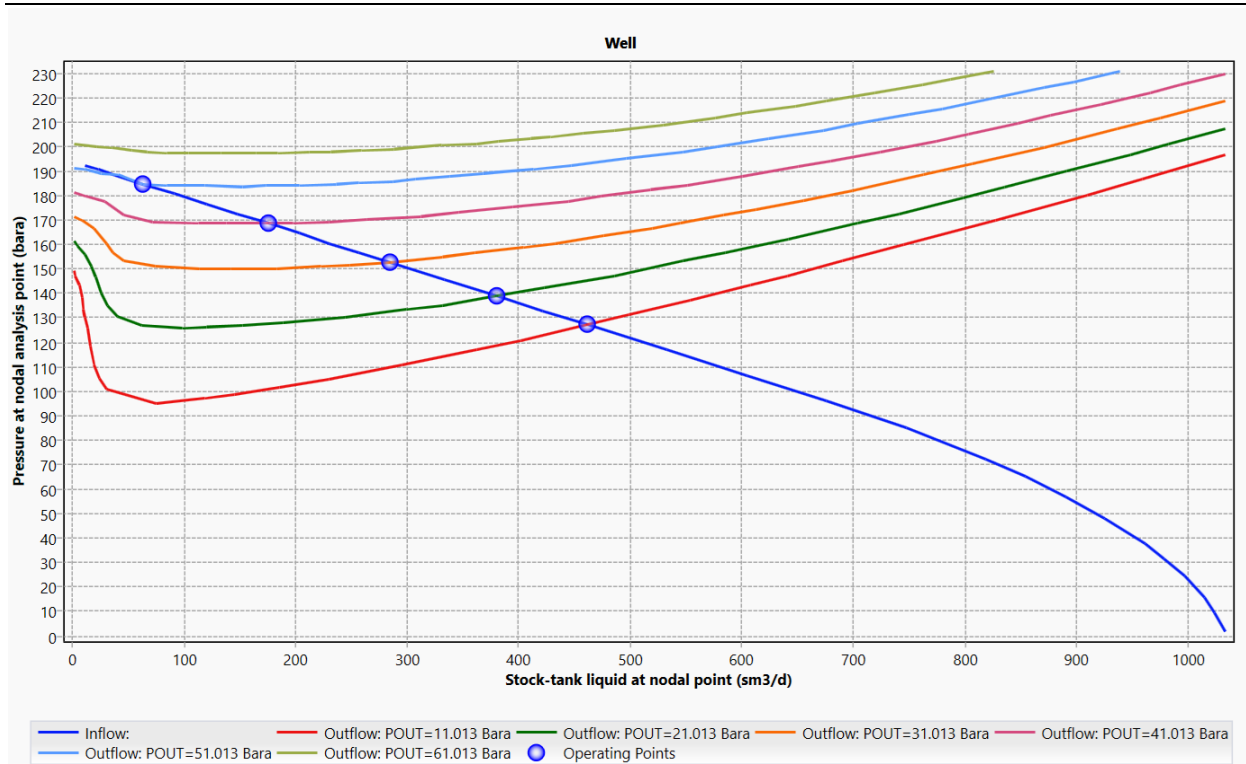
Рисунок 6.8. – Валанжинский горизонт. Зависимость минимальных забойных давлений фонтанирования от заданных давлений на устье Руст= 10; 20; 30; 40; 50; 51атм (НКТ 73 мм) при Рзаб > Рнас и Рпл=19,3МПа.
