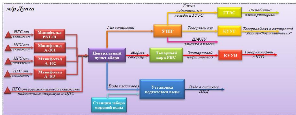
Рис. 6.3.2 – Принципиальная схема системы сбора и подготовки месторождения Дунга
