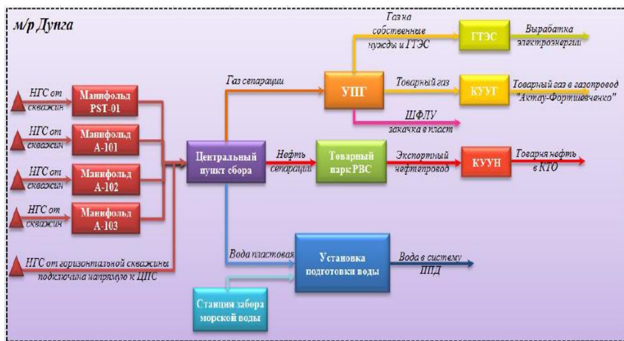
Рисунок 1.20- Принципиальная схема системы сбора и подготовки месторождения Дунга
