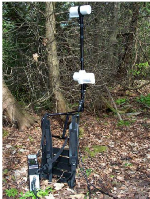
Рис. 5.11.1 Магнитометр GSM-19 в рабочем положении
