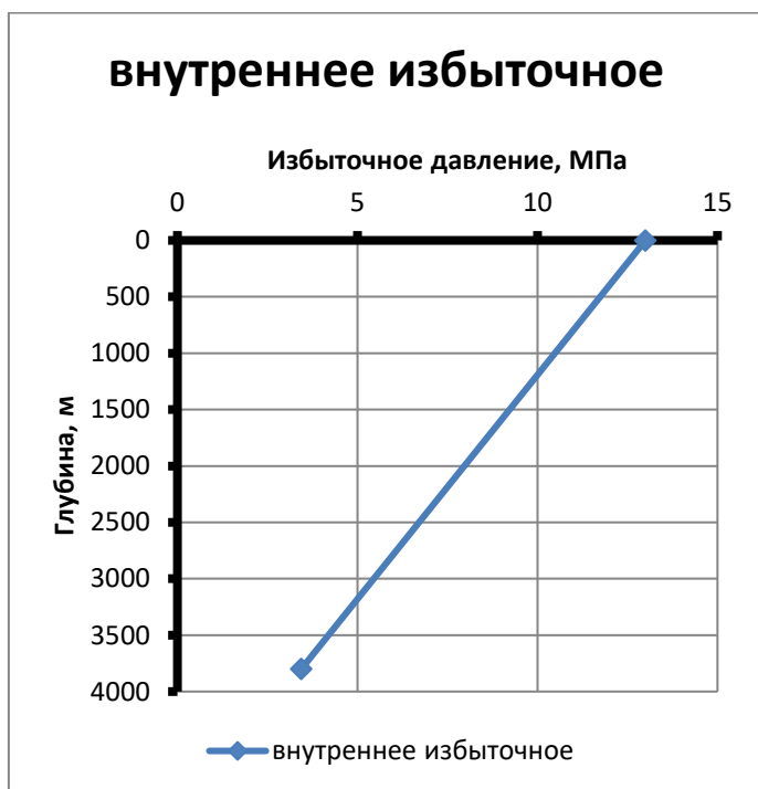
Рисунок 9-1. Распределение избыточных давлений (эксплуатационная колонна)
