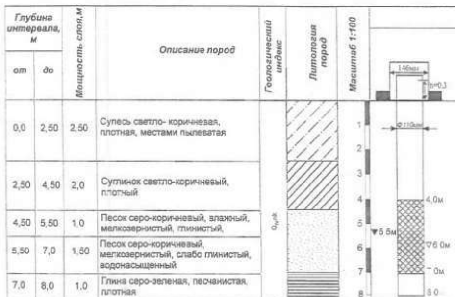
Геолого-технический разрез скважины пункта наблюдения №3н
