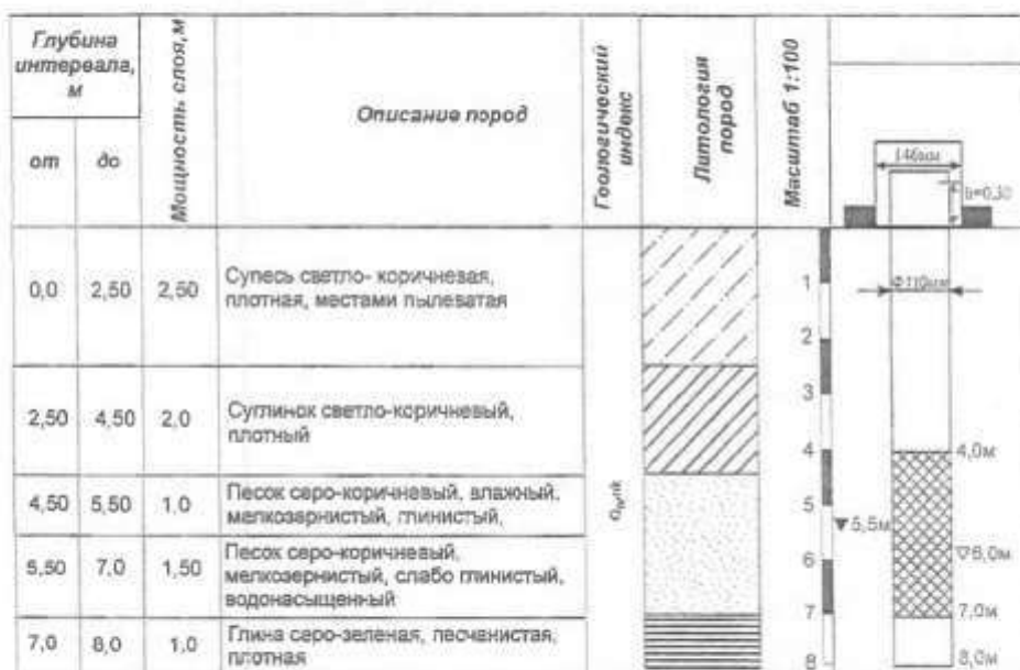
Геолого-технический разрез скважины пункта наблюдения №2н
