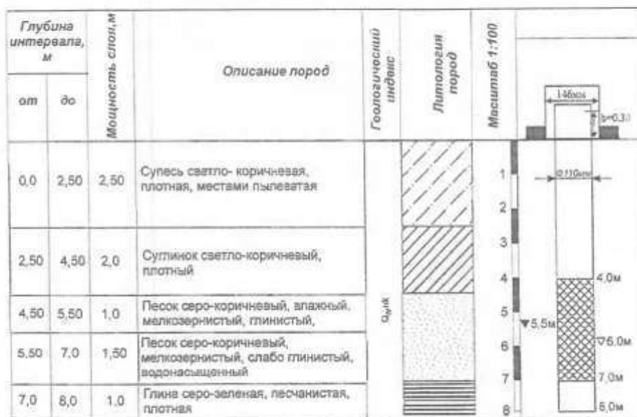
Геолого-технический разрез скважины пункта наблюдения №1н
