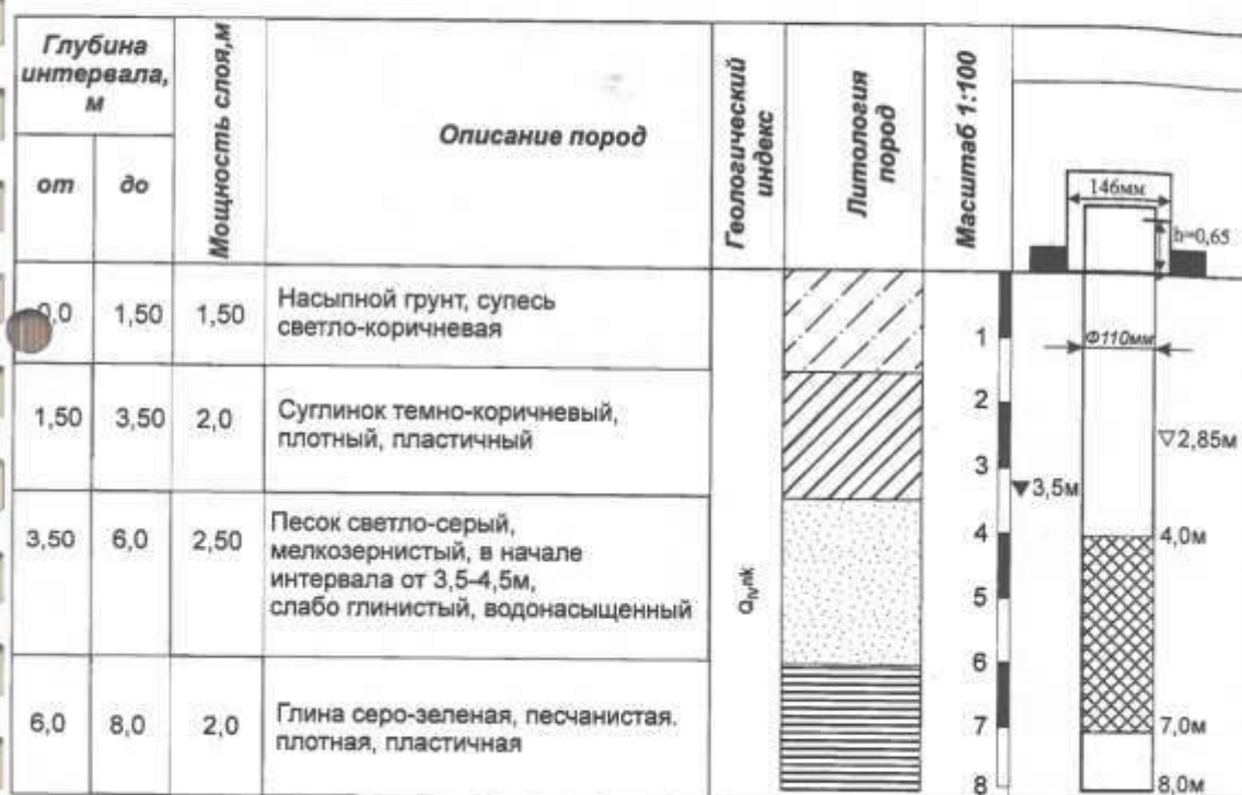
Геолого-технический разрез скважины пункта наблюдения № 5-н
