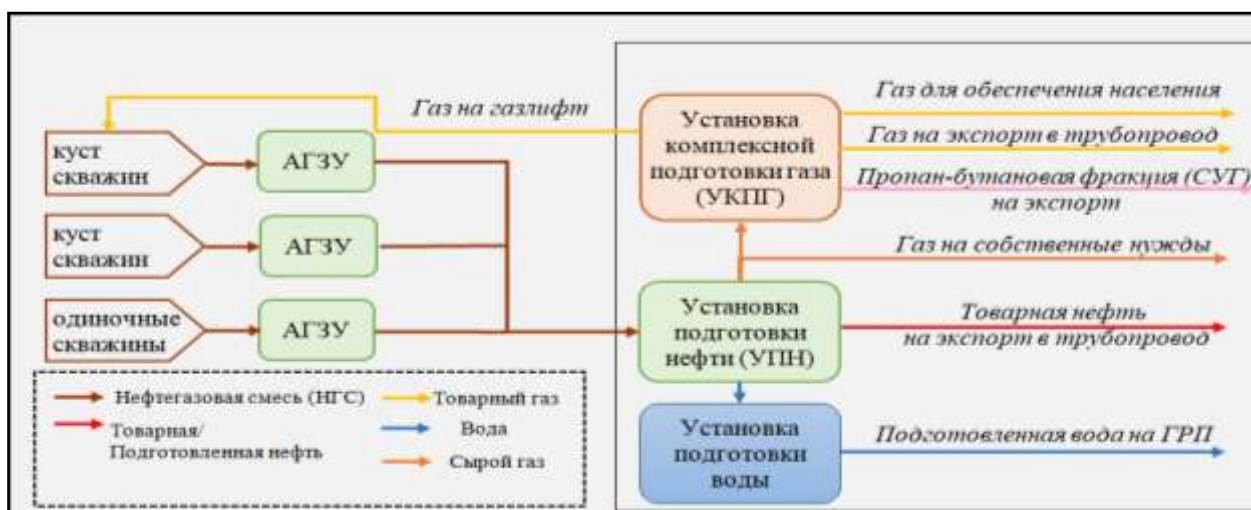
Рисунок 1.5.4.1 - Принципиальная схема системы сбора и подготовки
