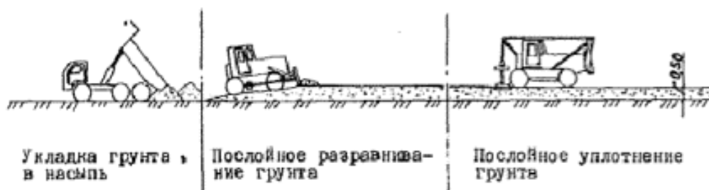
Рис. 9.2.1. Технология возведение насыпей.
