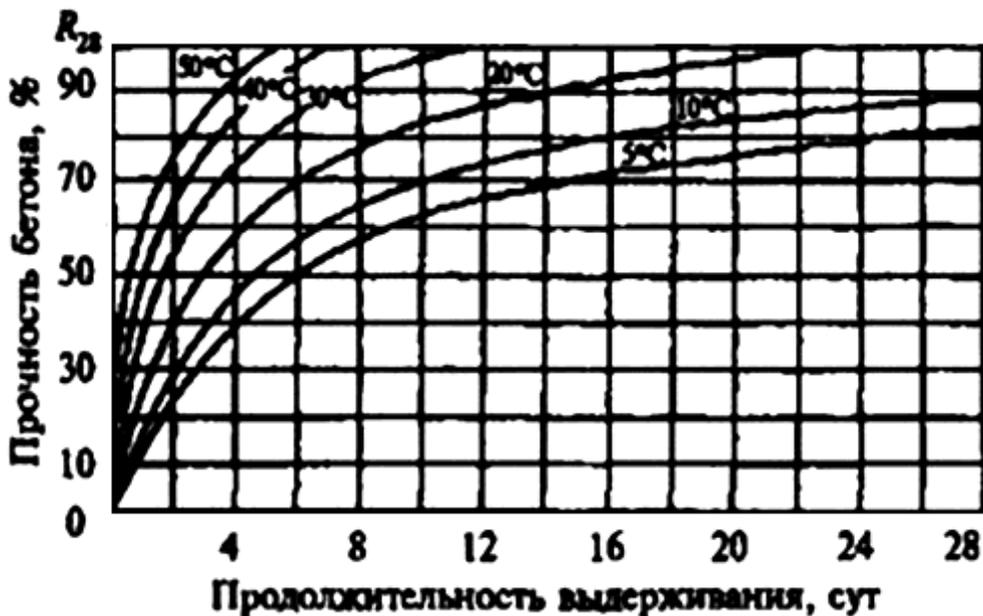
**Рис.9.16.1. Прочность бетона в зависимости от температуры и продолжительности выдерживания**
