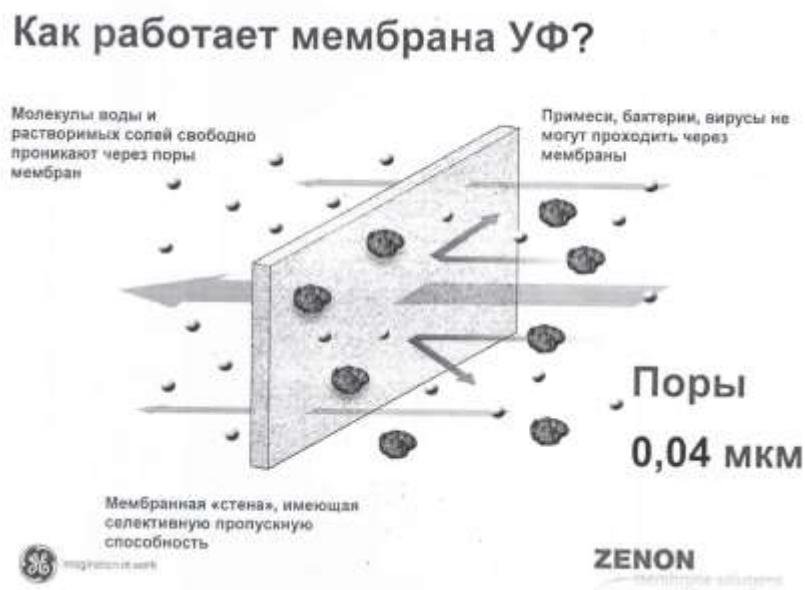
Рисунок 2.2 - Принцип работы мембранной установки
