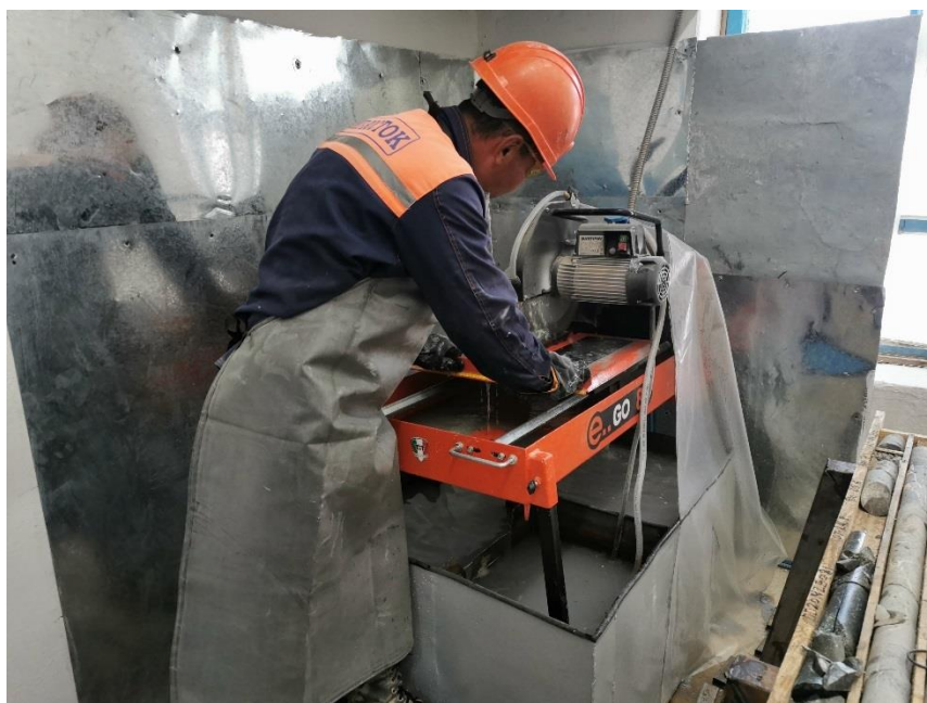
Рис.18 Камнерезный станок и распил керна
