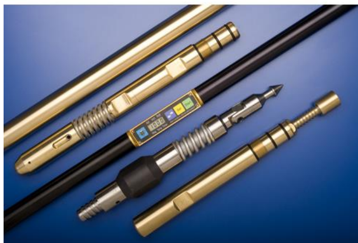
Рис.13 Комплект оборудования для замера инклинометрии от «Reflex»
