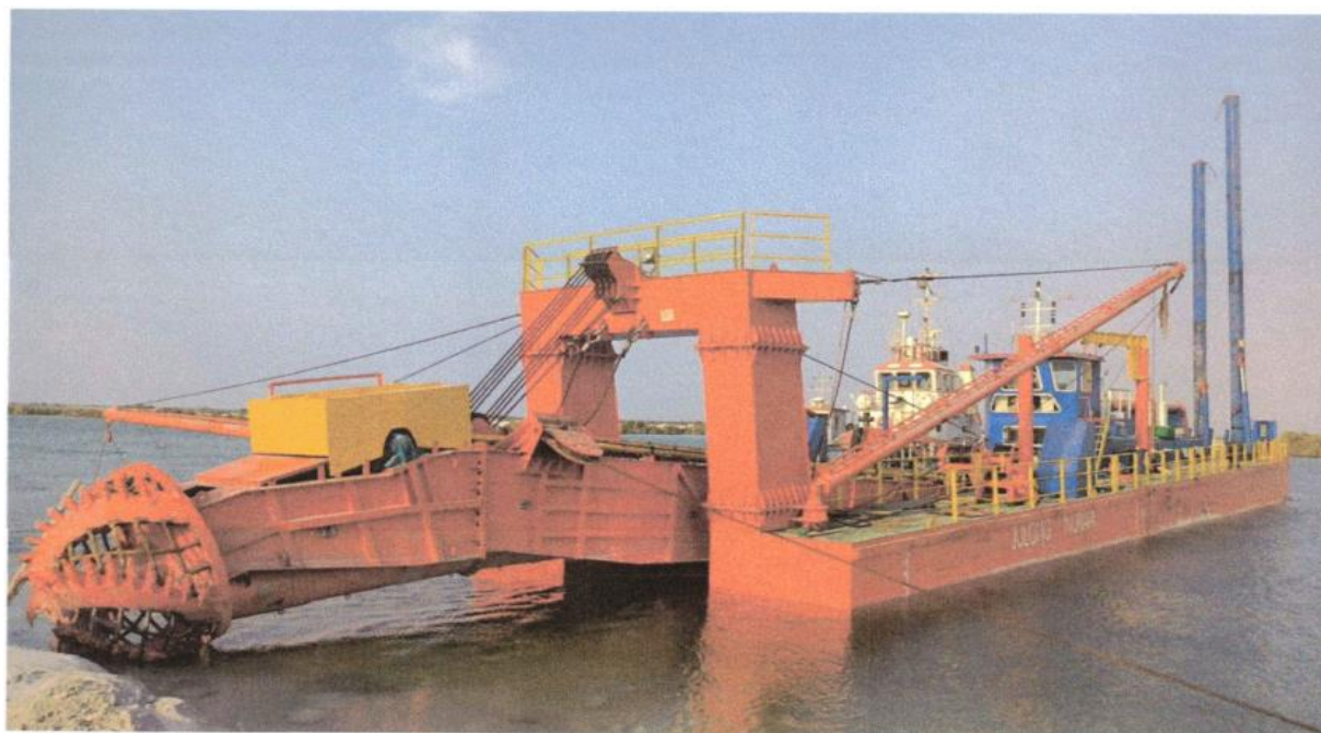
Рис. 11 Земснаряд с фрезерным разрыхлителем 26" модель CSD650
