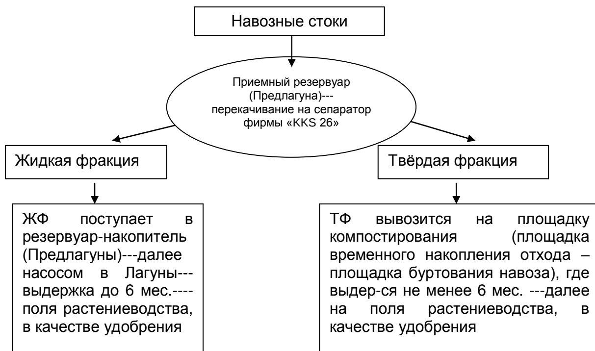
Рисунок 1 - Технологическая схема движения навозных стоков
