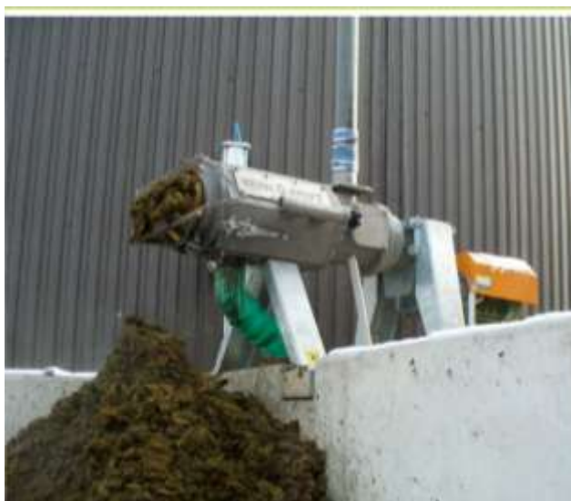
Рисунок 2 – Сепаратор шнековый фирмы «KKS 26» стационарный
