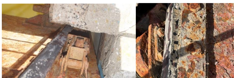
Рисунок 20 – Захваты деформированы и изношены
