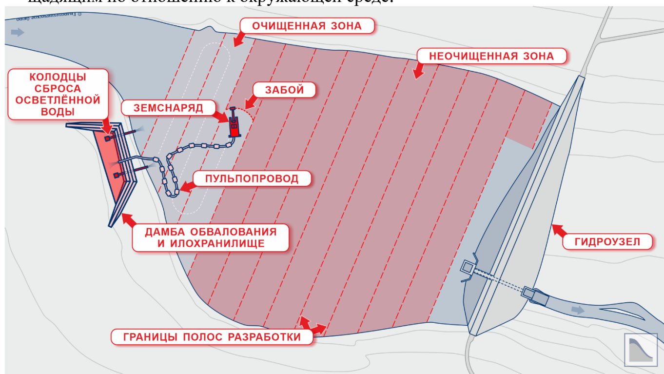
Рисунок 7 Технологическая схема очистки от донных отложений
