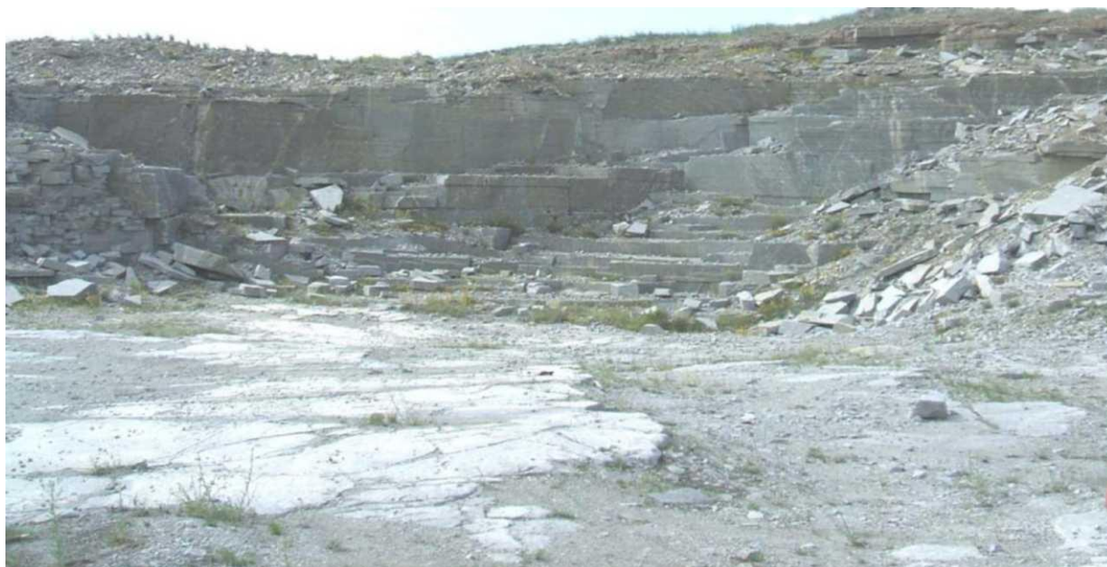
Трещиноватость и отдельность гранитов. Северо-восточный борт, горизонт +295
